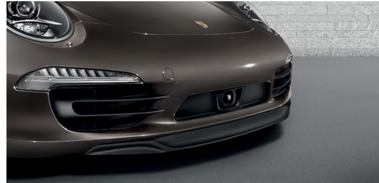
Sensore radar del sistema adattivo di regolazione della velocità (ACC)
