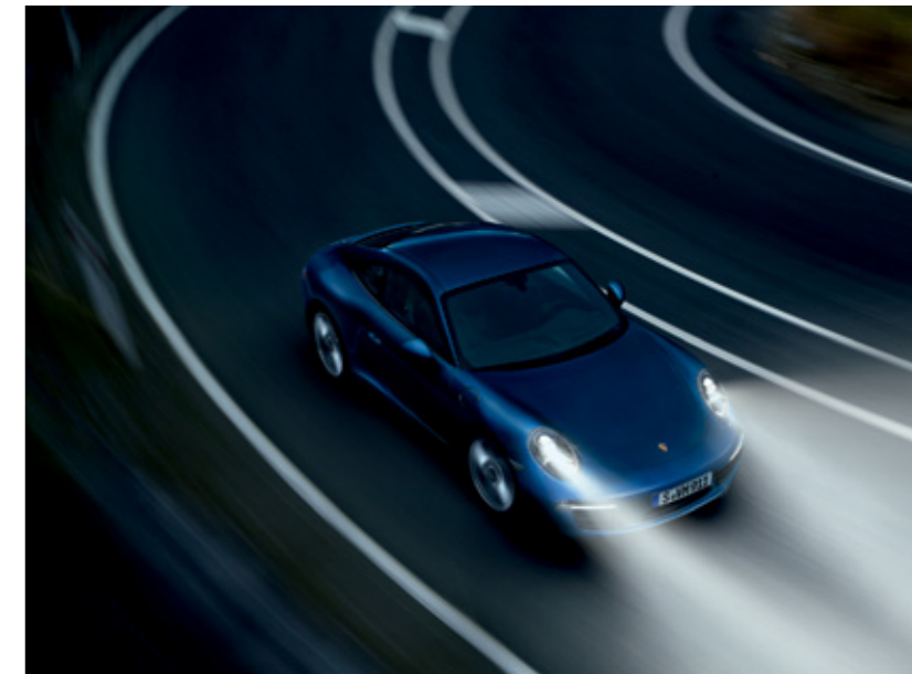
Regolazione della luce in curva del Porsche Dynamic Light System (PDLS)
