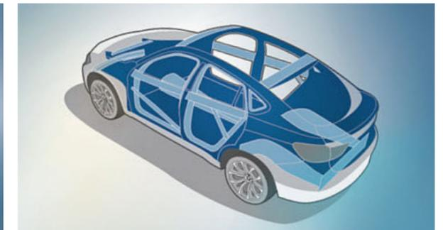
■ **Cellula abitacolo:** ottimizza la sicurezza passiva in caso di impatto grazie alla speciale configurazione delle strutture portanti e allo speciale collegamento dei punti nodali nonché ai materiali ad alta resistenza.
