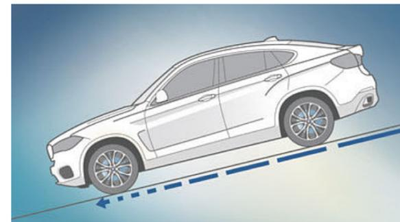
■ **Hill Descent Control (HDC):** controllo della marcia in discesa, di serie nei modelli xDrive. Fa in modo che la vettura superi automaticamente con sicurezza anche i tratti più ripidi, poco più che a passo d'uomo, senza che il guidatore debba frenare.
