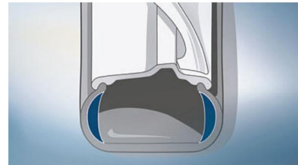
■ I sensori rilevano la **pressione del pneumatico** su ogni ruota. In caso di perdita di pressione l'apposita spia avverte tempestivamente il guidatore.
