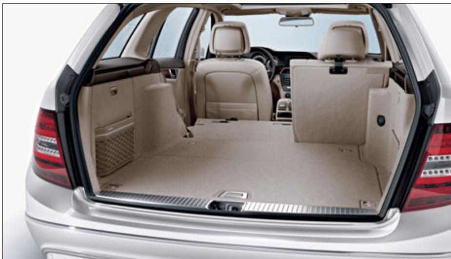
Il sedile posteriore è comodamente frazionabile nel rapporto 2/3 e consente di disporre di un versatile vano di stivaggio.
