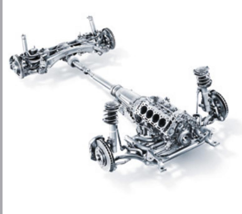
della dinamica di marcia e dei consumi. Su ghiaia, neve e nelle salite più impegnative, la trazione integrale permanente 4MATIC garantisce la massima motricità possibile grazie anche al sistema antislittamento (ASR), aumentando ulteriormente la stabilità di marcia.
