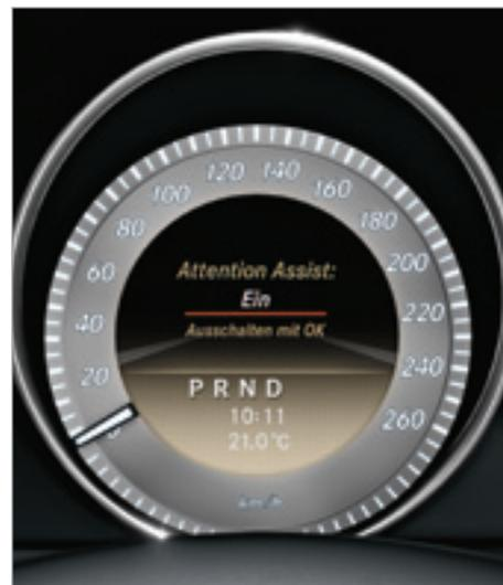
ATTENTION ASSIST. Questo nuovo sistema riconosce i sintomi di stanchezza del guidatore tra gli 80 e i 180 km/h, allertandolo non appena rileva le tipiche avvisaglie di stanchezza o di disattenzione. I sensori analizzano il comportamento di guida e riconoscono devianze significative dal profilo registrato.
