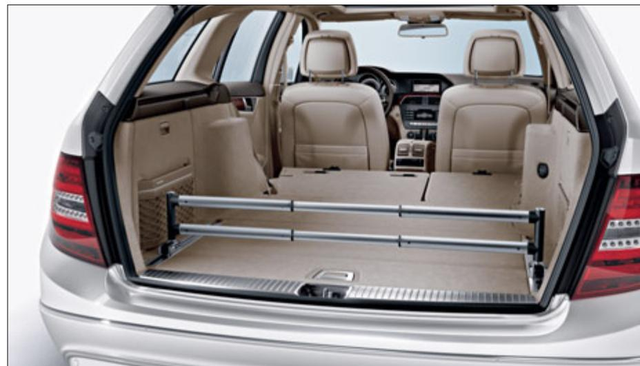
Grazie alle guide del vano di carico del kit di fissaggio EASY-PACK (a richiesta) è possibile ancorare oggetti nel bagagliaio in tutta sicurezza e semplicità.
