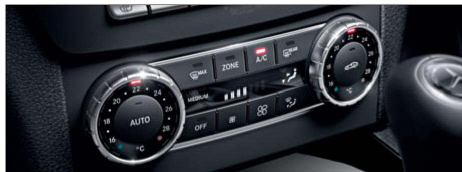
Il climatizzatore automatico COMFORTMATIC regola la temperatura e l'umidità dell'aria all'interno dell'abitacolo e assicura un gradevole microclima a bordo.
