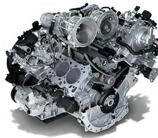
Motore biturbo V8 da 4,0 litri nella Cayenne Turbo Coupé
