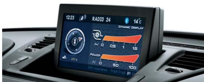
Il Radio NAV visualizza la pressione del turbocompressore e la potenza erogata in %.
