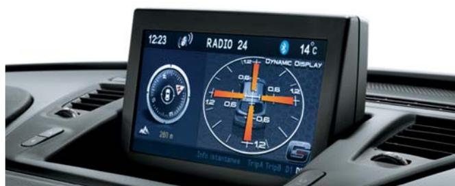
Il Radio NAV visualizza anche il valore dell'accelerazione (longitudinale e laterale) a cui è sottoposta la vettura.
