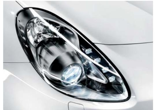
230 Proiettori Bi-Xeno con Adaptive Frontlight System
