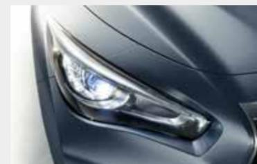
**UN MODO PIÙ INTELLIGENTE DI VEDERE.** L'impianto di illuminazione anteriore con sistema adattivo non illumina soltanto lo spazio frontale, ma anche quello laterale. Dirige infatti la luce verso gli angoli spostando i fari mediante un comando sincronizzato posto sullo sterzo. In aggiunta a tutto questo, Infiniti Q50 introduce la tecnologia High Beam Assist che riduce l'intensità degli abbaglianti all'avvicinarsi dei veicoli durante la guida notturna (disponibile in optional).
