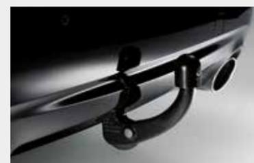
**BARRA DI TRAINO** Testata per rispondere ai massimi requisiti in termini di sicurezza e funzionalità, la barra di traino viene incontro alle tue esigenze ovunque tu sia. Integrata nella carrozzeria della tua auto, ha una capacità di traino pari a 1,5 tonnellate. La barra di traino può essere rimossa facilmente se non necessaria.
