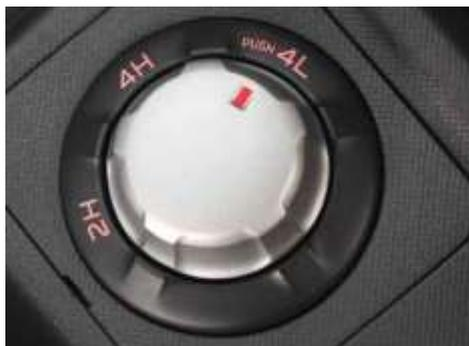
Inserimento 4x4 e ridotte tramite comando su tunnel centrale.
