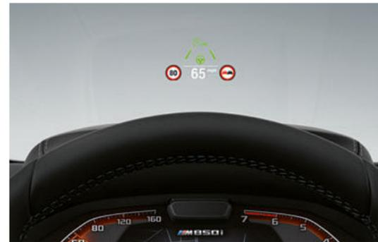
IL BMW HEAD-UP DISPLAY VISUALIZZA LE INFORMAZIONI RILEVANTI PER LA GUIDA DIRETTAMENTE NEL CAMPO VISIVO DEL CONDUCENTE.
