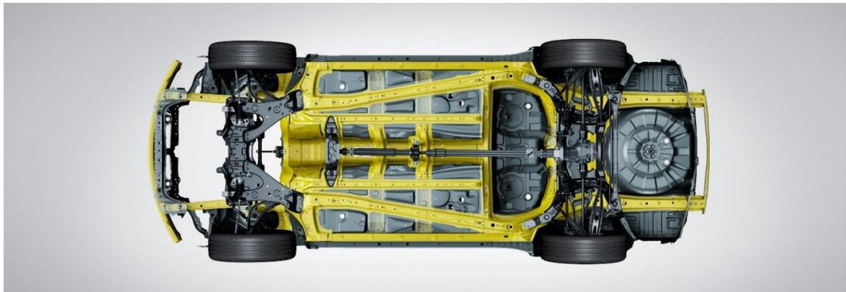
La nuova Subaru Outback utilizza la piattaforma SGP (Subaru Global Platform) che ha introdotto rilevanti miglioramenti in termini di rigidità e quindi di sicurezza, ridotte vibrazioni e una minor rumorosità nell'abitacolo.
