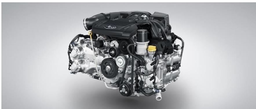
La nuova Subaru Outback utilizza il motore Boxer a benzina da 2,5l FB25, **modificato per il 90% dei suoi componenti**. Primo tra tutti il sistema di iniezione del carburante che passa da "indiretto" a "diretto". Ne hanno tratto vantaggio sia l'erogazione della potenza, che la curva di coppia (+7%), a beneficio di un funzionamento più fluido, rotondo e con emissioni e consumi ridotti.
