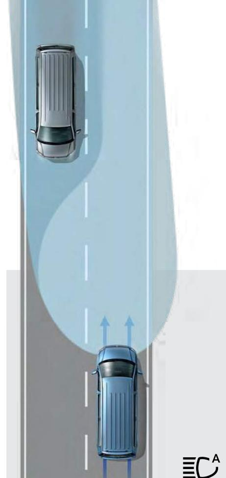
**Regolazione degli abbaglianti "Light Assist".** Se il sistema rileva veicoli provenienti in senso contrario o che precedono la vettura, viene attivata automaticamente la posizione antiabbagliamento. A partire da una velocità di 60 km/h, in condizioni di totale oscurità, il sistema attiva automaticamente gli abbaglianti.<sup>5)</sup>
