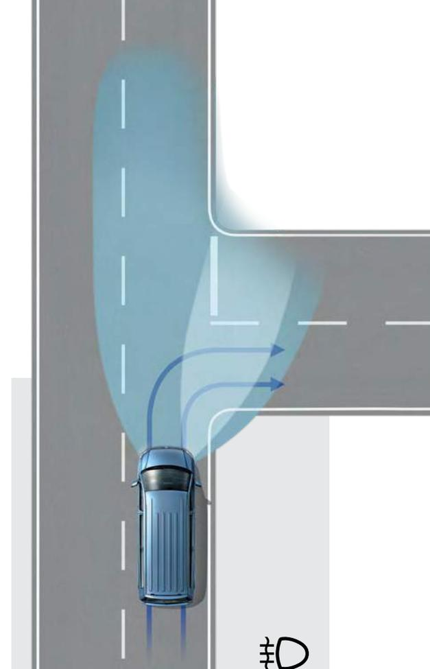
**Fendinebbia con luci di svolta integrate.** Garantiscono una visibilità ottimale in caso di condizioni atmosferiche avverse. In fase di svolta, il faro interno alla curva illumina il ciglio della strada.
