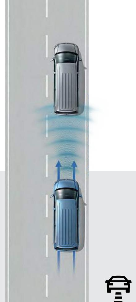
**"Cruise Control" con regolazione automatica della distanza (ACC).** Tramite uno specifico sensore il sistema misura la distanza del veicolo rispetto alla vettura che lo precede (fino a 120 m) nonché la velocità dello stesso e mantiene automaticamente la distanza desiderata.<sup>1), 5)</sup> Comprende già il sistema di controllo perimetrale "Front Assist".
