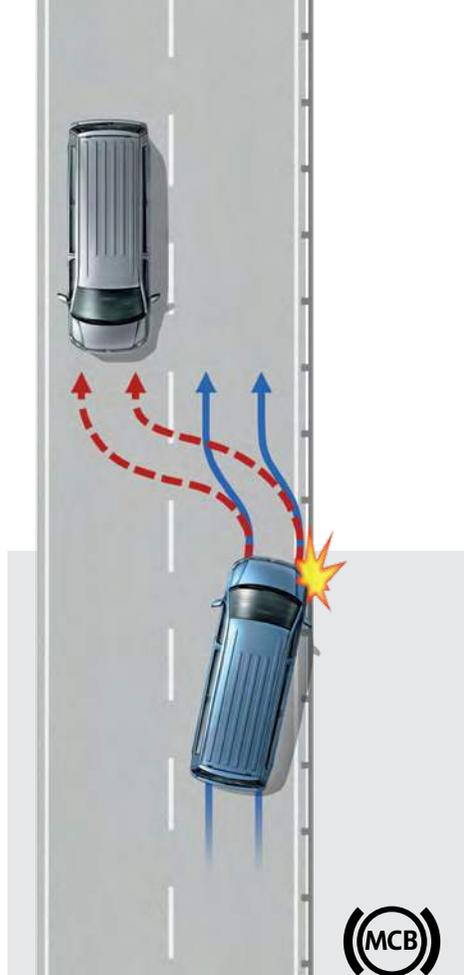
**Sistema di frenata Anti Collisione Multipla "Multi Collision Brake".** In caso di urto o di tamponamento, il sistema di frenata Anti Collisione Multipla "**Multi Collision Brake**" attiva automaticamente una frenata del veicolo in modo da evitare impatti successivi o attenuarne gli effetti.<sup>1), 3)</sup>
