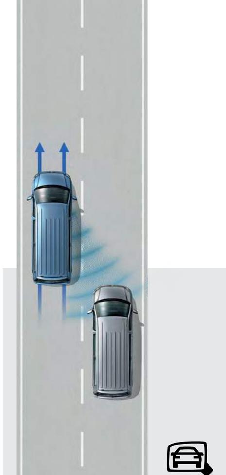
**Sistema di assistenza per cambio di corsia "Side Assist".** Tramite un'indicazione nello specchietto retrovisore esterno,<sup>1)</sup> segnala immediatamente, in caso di cambio di corsia, la presenza nell'angolo cieco di una vettura individuata dai sensori.<sup>5)</sup>
