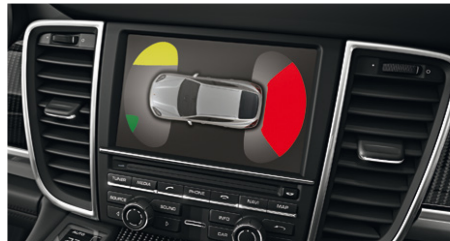
Riproduzione schematica del ParkAssistant anteriore e posteriore
