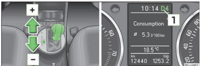
Fig. 84 Leva selettoria: cambio manuale delle marce / display informativo: Cambio manuale delle marce
