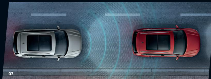
03. **Adaptive Cruise Control.** Controlla automaticamente la velocità in base alla posizione dei veicoli che precedono per mantenere la distanza di sicurezza.
