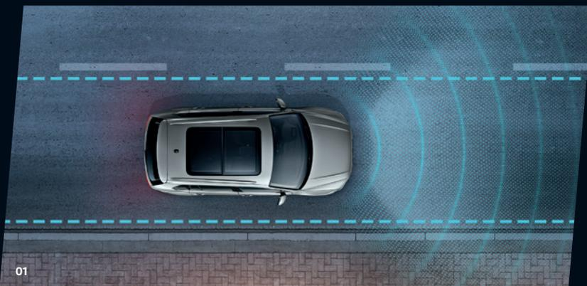
01. **Lane Assist.** Il sistema di controllo della traiettoria di marcia rileva la segnaletica orizzontale e aiuta il guidatore a mantenere correttamente la propria corsia.
