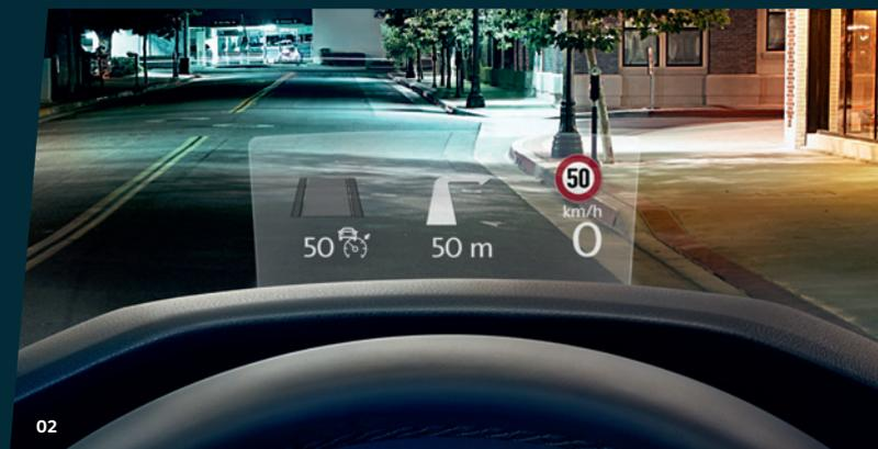
02. Il sistema **"Head-up Display"** ti permette di avere sempre la strada sott'occhio visualizzando la velocità, le indicazioni di navigazione e quelle dei segnali stradali direttamente su una superficie trasparente estraibile sopra il parabrezza. Così puoi mantenere lo sguardo sulla strada e concentrarti pienamente sulla guida. Grazie all'elevata luminosità, le informazioni rimangono ben visibili, anche se si è esposti a luci dirette provenienti da altre vetture sulla corsia opposta. **E**
