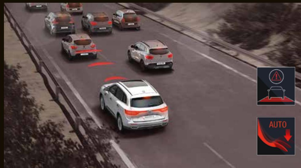
**Frenata d'emergenza attiva.** Il sistema interagisce con l'ABS/ESC per ridurre lo spazio di arresto nel caso di una frenata d'emergenza.
