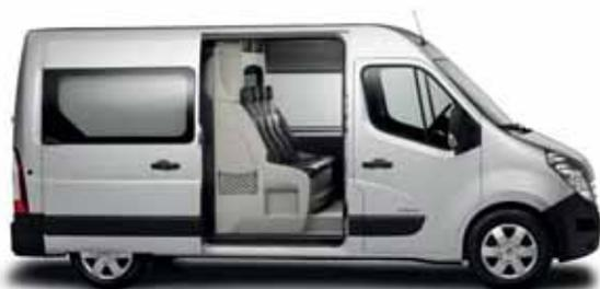
Il nuovo Master Furgone a doppia cabina è il veicolo ideale per il trasporto sia di merci (fino a 9 m<sup>3</sup> e 1350 kg di carico utile) e persone (fino a 7 perone). La particolare panchetta in 2° fila, con seduta sollevabile, consente di avere fino a 3,5 m di lunghezza utile al pianale.
