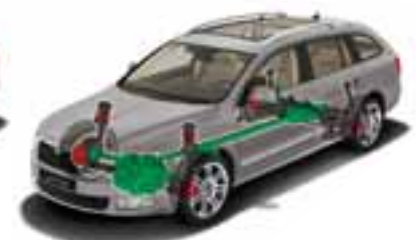
Superb Wagon con trazione integrale e frizione Haldex di 4a generazione (motori 1.8 TSI/118kW, 3.6 FSI V6/191kW, 2.0 TDI CR FAP/103kW e 2.0 TDI CR FAP/125kW)
