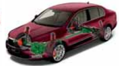
Superb con trazione integrale e frizione Haldex di 4a generazione (motori 1.8 TSI/118kW, 3.6 FSI V6/191kW, 2.0 TDI CR FAP/103kW e 2.0 TDI CR FAP/125kW)
