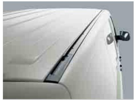
**Guide a C.** Le rotaie a C nelle canaline sul tetto servono per fissare i portapacchi in modo flessibile e sono disponibili esclusivamente per i veicoli con tetto normale.
