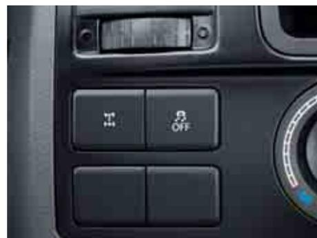
Il **bloccaggio meccanico del differenziale**. In abbinamento a 4MOTION, per l'assale posteriore è disponibile un bloccaggio meccanico del differenziale.
