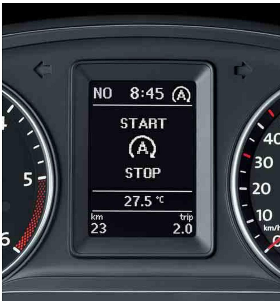
**Sistema Start/Stop.** Mettendo in folle e rilasciando la frizione, il motore si spegne automaticamente, ad esempio ai semafori rossi. Per riavviare il motore basta premere la frizione.
