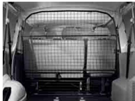
La **griglia divisoria**. Robusta, d'acciaio, con rivestimento nero a polveri può essere fissata facilmente agli appositi occhielli sul retro dei sedili posteriori. Non sono necessari fori alla carrozzeria; pertanto, può essere facilmente smontata senza lasciare segni.
