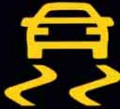
Il programma elettronico di stabilità (ESP) con bloccaggio elettronico del differenziale (EDS). L'elettronica impedisce al veicolo di sbandare intervenendo in modo mirato sulla gestione dei freni e del motore.<sup>2)</sup>
