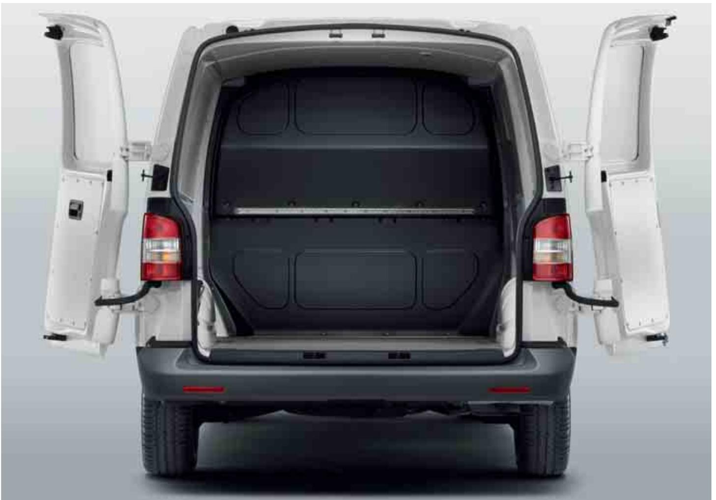
Le porte posteriori a battente. Per Transporter con tetto normale e medio, le porte posteriori a battenti sono disponibili su richiesta (senza sovrapprezzo per furgone), mentre per Transporter con tetto alto sono di serie. Nella versione a passo lungo, su richiesta le porte a battente possono anche essere dotate di angolo di apertura di 250° ed essere bloccate di lato. Inoltre possono essere dotate di reti fermabagagli.
