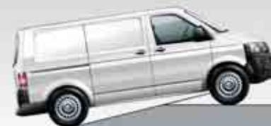
L'**angolo di rampa: 14°**. Per consentire di affrontare anche strade impervie e piccole alture, Transporter supera facilmente anche collinette con un angolo di rampa fino a 14°. Misurato con equipaggiamento di serie e a pieno carico.
