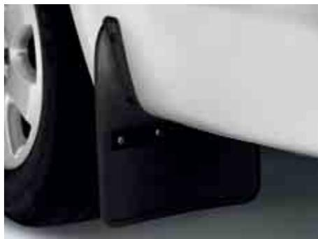
I **paraspruzzi**. Su misura, sono estremamente resistenti e durevoli. Proteggono il sottoscocca, il paraurti e la parte posteriore del veicolo dallo sporco. Inoltre, riducono il rischio di colpi dannosi e minimizzano la deviazione degli spruzzi d'acqua.
