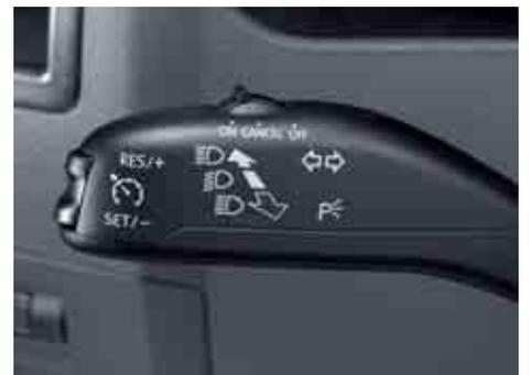
**Il regolatore di velocità.** A partire da 30 km/h è possibile mantenere costante la velocità selezionata premendo un pulsante. È sufficiente premere leggermente il freno per disattivare il regolatore.
