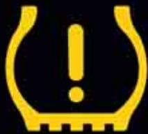
Il sistema di controllo pressione pneumatici. In caso di perdita di pressione in una delle quattro ruote appare un simbolo di avviso che indica di controllare al più presto la pressione dei pneumatici.
