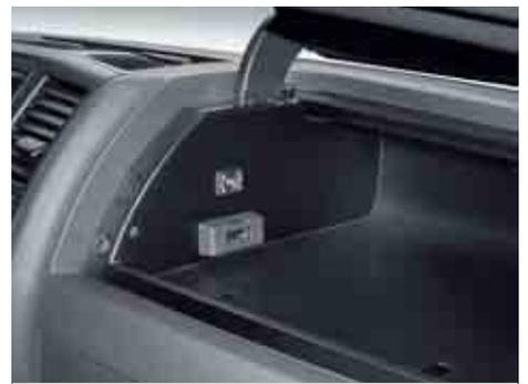
Le **interfacce AUX-IN e MEDIA-IN**. Alla presa Cinch o al cavo adattatore USB è possibile collegare sorgenti audio esterne, ad es. un lettore CD e MP3, che vengono comandate attraverso il sistema di radio e navigazione.\*
