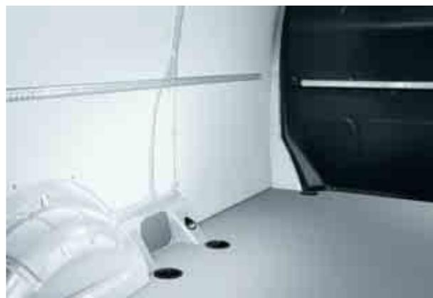
**Un robusto pavimento in legno per il vano di carico e occhielli e barre fermacarico sulle fiancate e sulla parete divisoria.**
