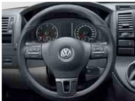
**Il volante multifunzione.** Gli interruttori integrati consentono di comandare la radio, il regolatore di velocità e un telefono cellulare. Il volante è rivestito in pelle ed è regolabile in altezza e inclinazione.
