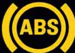
Il sistema antibloccaggio delle ruote (ABS). Impedisce che le ruote si blocchino completamente, migliorando la sterzabilità del veicolo in caso di frenata a fondo.
