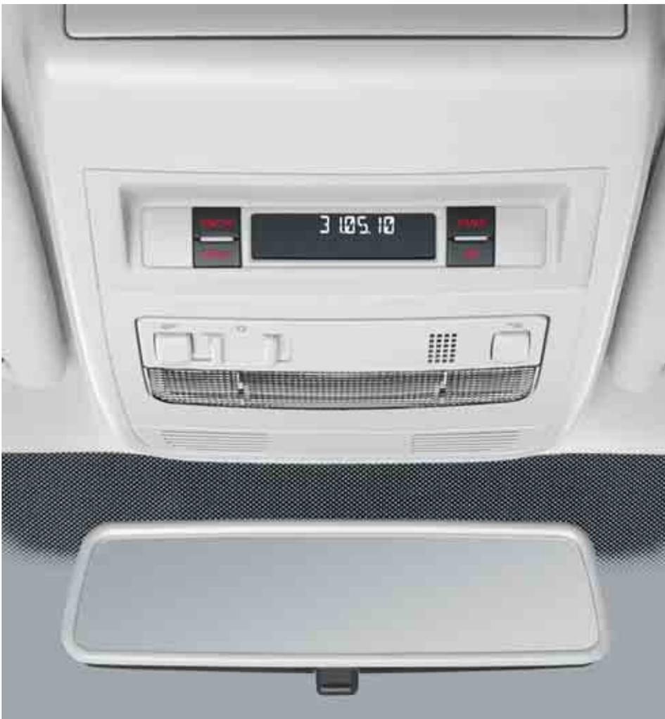
**Il riscaldamento autonomo.** Quando fa freddo, il riscaldamento autonomo non garantisce solo il massimo comfort, ma anche una maggiore sicurezza: i vetri non ghiacciano e l'appannamento interno si riduce. Opzionalmente può essere comandato con un telecomando.
