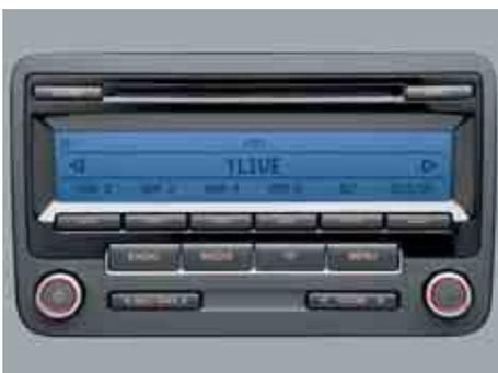
L'impianto radio "RCD 310". Dispone di tutte le funzioni di "RCD 210", con in più quattro altoparlanti nella cabina, un'interfaccia AUX-IN nel cassetto portaoggetti, l'antenna diversity, il display adatto per il ParkPilot.
