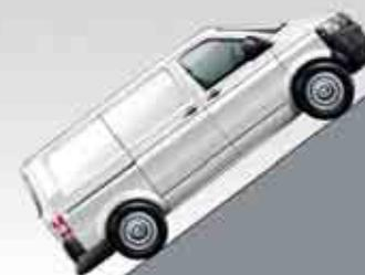
La **pendenza superabile: 37°**. Transporter con motore da 132 kW\* e peso di 3.000 kg è in grado di superare senza fatica pendenze fino a 37°.
