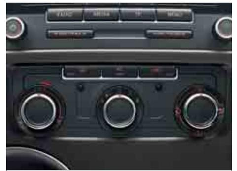
**Il climatizzatore "Climatic".** Dispone di un sensore nell'abitacolo e adatta continuamente la temperatura ambiente al livello di calore desiderato. I gradi, la ripartizione dell'aria e la velocità della ventola possono essere regolati individualmente.
