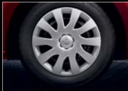
Cerchi in acciaio da 16" a 5 razze con copriuota integrali a 10 raggi, 6 J x 16", pneumatici 215/65 R 16 (QP9) 2 .
