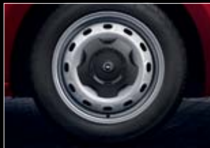
Cerchi in acciaio da 16" con tappo centrale, 6 J x 15", pneumatici 205/65 R 16 (P91) 1 .
