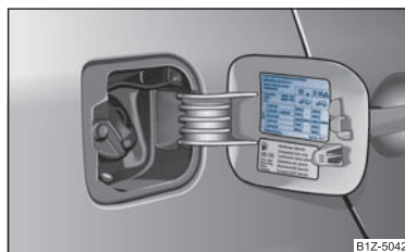
Fig. 129 Sportello serbatoio con una tabella sulla dimensione e sui valori di gonfiaggio dei pneumatici
