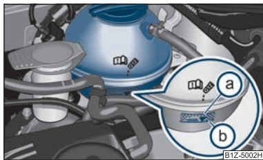
Fig. 124 Vano motore: Serbatoio di espansione liquido di raffreddamento
