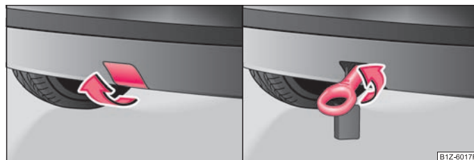
Fig. 142 Paraurti posteriore: Smontaggio della copertura / Montaggio dell'occhione di traino
