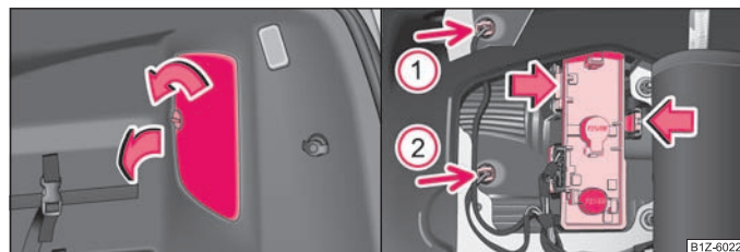
Fig. 152 Bagagliaio: Coperchio del portalampade / smontaggio del portalampade
