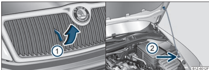
Fig. 121 Griglia radiatore: Leva di sbloccaggio / Fermo del cofano motore con sostegno
