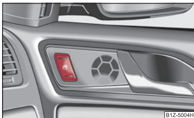
Fig. 33 Disposizione dei tasti sulla porta lato passeggero
