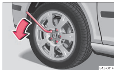
Fig. 137 Sostituzione di una ruota: Allentamento dei bulloni
