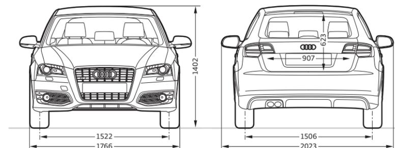
**Misure in millimetri.**
