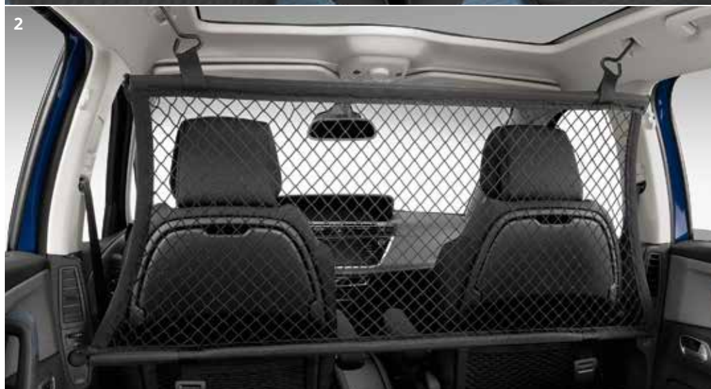
1 - Griglia di separazione per cani 2 - Rete di fermo per carichi alti
