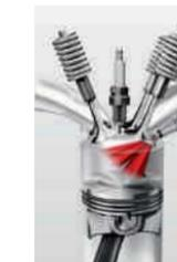
La centralina del motore calcola la quantità di carburante da iniettare e il punto d'accensione sulla base della potenza richiesta dal conducente. Nel funzionamento normale la pressione d'iniezione varia tra 30 e 120 bar. Il motore di Audi A8 dispone per la prima volta di iniettori ad alta pressione con ugelli multiforici che assicurano la distribuzione ottimale del carburante nel cilindro.
