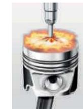
**La preiniezione** consente una combustione «morbida» e quindi una minore rumorosità e un funzionamento più dolce del motore.
