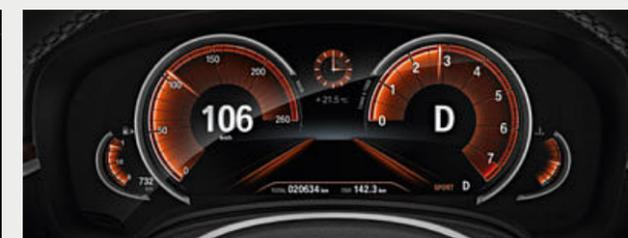
□ Il display strumenti multifunzionale con tecnologia Black Panel e diagonale dello schermo di 12,3" offre una visualizzazione ottimale dell'esperienza di guida. Tre diverse modalità con schermate specifiche ognuna con schema colori e stile grafico possono essere visualizzate sul quadro strumenti: ECO PRO, COMFORT e SPORT.
