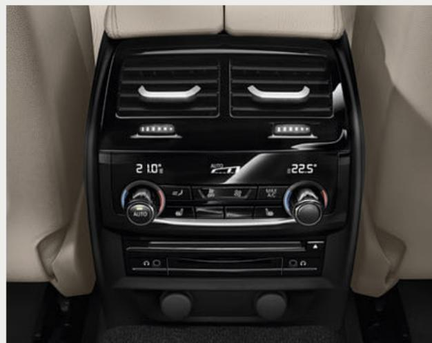
□ Oltre che delle funzioni del climatizzatore bi-zona con funzioni estese, il climatizzatore automatico quadizona è dotato di due bocchette d'aria supplementari nei montanti centrali. Inoltre la temperatura del retro dell'abitacolo è regolabile con un comando separato dotato di display.
