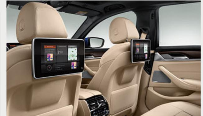
□ Il sistema di intrattenimento per i passeggeri posteriori<sup>2</sup> comprende due display a colori separati da 10,2" a inclinazione regolabile e un lettore Blu-ray. Si può utilizzare per gestire il sistema di navigazione<sup>3</sup> o guardare la televisione (se si dispone anche del optional Funzione TV Digitale). Il sistema include un telecomando e porte per lettori MP3, console per videogiochi e cuffie (anche wireless).
