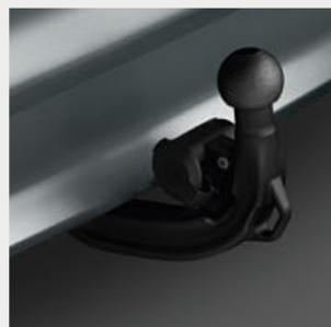
□ Il gancio di traino con sfera regolabile elettronicamente e controllo di stabilità del rimorchi è in grado di trainare carichi pesanti fino a 2.000 kg.
