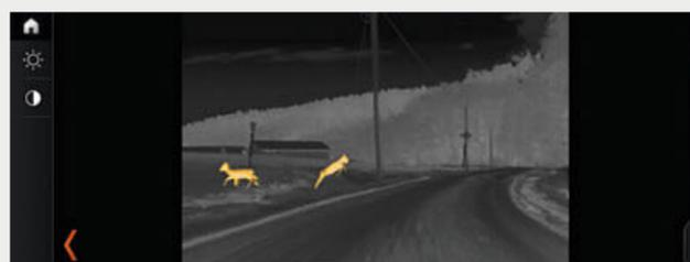
□ Il BMW Night Vision con sistema di riconoscimento automatico delle persone rende possibile l'identificazione delle persone e degli animali di grandi dimensioni a grande distanza di notte grazie a un'immagine termica sul Control Display e le illumina in modo mirato con il Dynamic Marker Light dei gruppi ottici principali. Un sistema di allerta aggiuntivo si attiva automaticamente accendendo il veicolo, indipendentemente dalle immagini visualizzate sul display.
