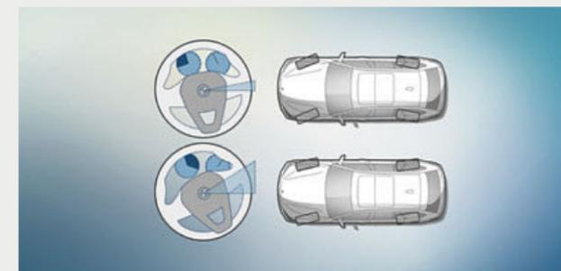
□ **L'Integral Active Steering** combina una demoltiplicazione che dipende dall'angolo di sterzata sull'asse anteriore e un asse posteriore sterzante. Alle basse velocità le ruote posteriori sterzano in direzione opposta rispetto a quella delle ruote anteriori, per cui migliorano la manovrabilità e l'agilità. Da circa 60 km/h le ruote posteriori sterzano nella stessa direzione delle ruote anteriori, aumentando la stabilità di marcia e il comfort.
