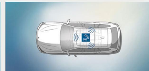
■ **L'Emergency Call** mette in contatto in qualsiasi momento il conducente con il centro di coordinamento del soccorso attraverso il BMW Call Centre, senza bisogno di un telefono cellulare. Trasmette informazioni riguardanti la posizione del veicolo e la gravità dell'incidente. L'Emergency Call può essere effettuata anche manualmente, ad esempio nel caso di necessità di altri utenti della strada.
