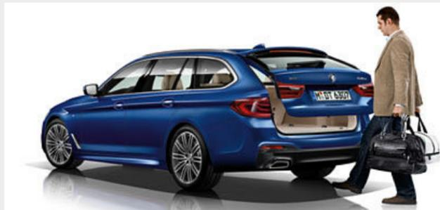
□ Il Comfort Access System permette di aprire e chiudere tutte le portiere della vettura senza prendere in mano la chiave. L'equipaggiamento comprende l'apertura e la chiusura senza contatto del portellone posteriore con un piccolo movimento del piede sotto il paraurti posteriore.
