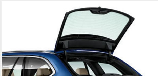
■ Premendo un pulsante sulla chiave della vettura è possibile azionare l'apertura separata del lunotto per caricare e scaricare i bagagli. Un aspetto particolarmente pratico: all'apertura l'avvolgibile si solleva automaticamente e, quando si richiude manualmente il lunotto, copre di nuovo il vano bagagli.
