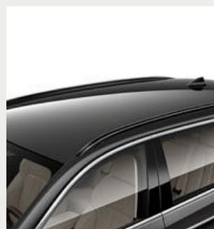
■ Le Barre longitudinali sul tetto in nero opaco permettono di fissare facilmente il portabagagli multiuso BMW per trasporto di oggetti ingombranti.
