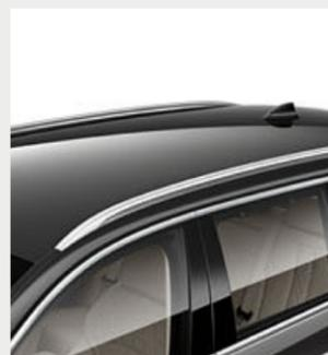
□ Le eleganti barre longitudinali sul tetto in Silver opaco costituiscono il supporto per il montaggio del portabagagli multiuso BMW per trasporto di colli ingombranti.
