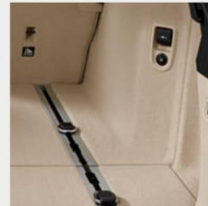
■ Lo sblocco a distanza dello schienale posteriore permette allo schienale di essere sbloccato e ripiegato comodamente con un pulsante nel vano bagagli.
