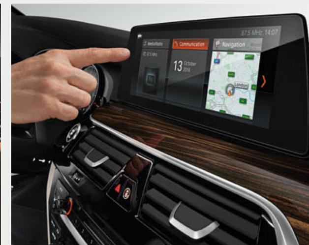
□ Con il BMW Gesture Control è possibile attivare determinate funzioni con alcuni movimenti della mano. Per determinati comandi il sistema riconosce gesti prestabiliti, ad esempio il gesto di cancellare o indicare, con cui si può rifiutare o accettare una chiamata in arrivo, o i movimenti rotatori del dito indice, con cui si può regolare il volume.
