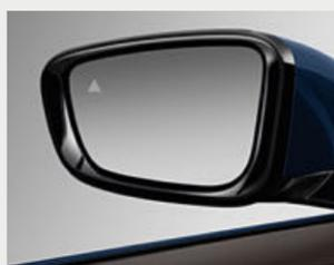
□ Il segnalatore di sorpasso pericoloso (parte del Driving Assistant) riconosce le vetture presenti nell'«angolo cieco» e avverte il guidatore tramite un lampeggiamento delle luci a LED nei retrovisori esterni e vibrazioni del volante.
