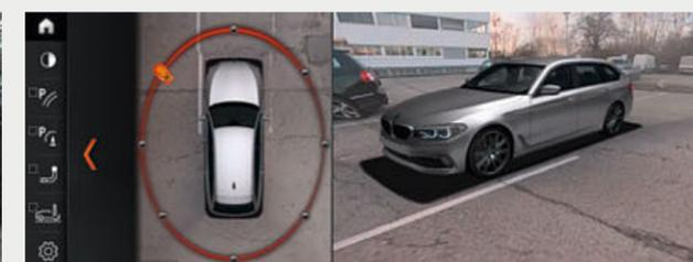
□ Il pacchetto di equipaggiamenti Parking Assistant Plus facilita le manovre per il parcheggio della vettura. Comprende Surround View con Top View, Remote 3D View, PDC, un assistente laterale per il parcheggio, la funzione di frenata d'emergenza Active PDC e l'assistente di parcheggio con guida in direzione longitudinale, che parcheggia la vettura automaticamente in senso parallelo o trasversale alla corsia di marcia.
