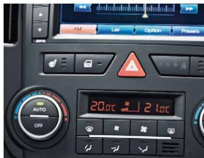
Il climatizzatore automatico dispone della funzione dual zone.
