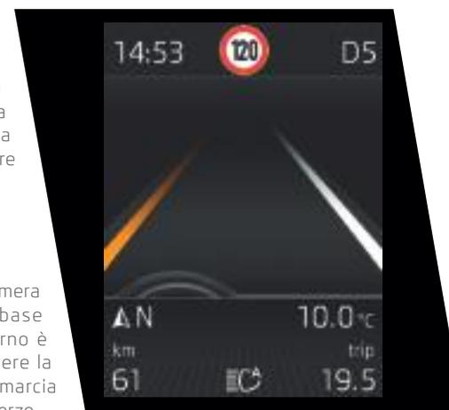
Un altro sistema che utilizza la telecamera multifunzione posizionata alla base dello specchietto retrovisore interno è il Lane Assist, in grado di mantenere la vettura all'interno della corsia di marcia intervenendo direttamente sullo sterzo.
