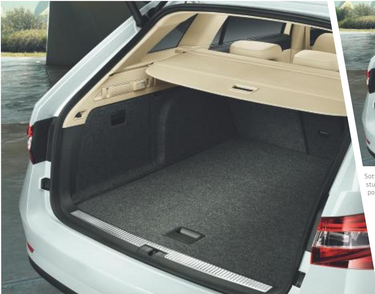
All'apertura del portellone ad azionamento elettrico, la cappelliera avvolgibile si sposta automaticamente in posizione centrale, agevolando l'accesso al vano bagagli.
