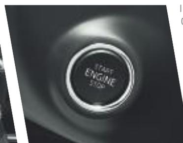
Le vetture con sistema KESSY (Keyless Entry, Start and exit SYstem) sono dotate di un pulsante Start/Stop sul piantone dello sterzo per avviare e spegnere il motore senza utilizzare la chiave.
