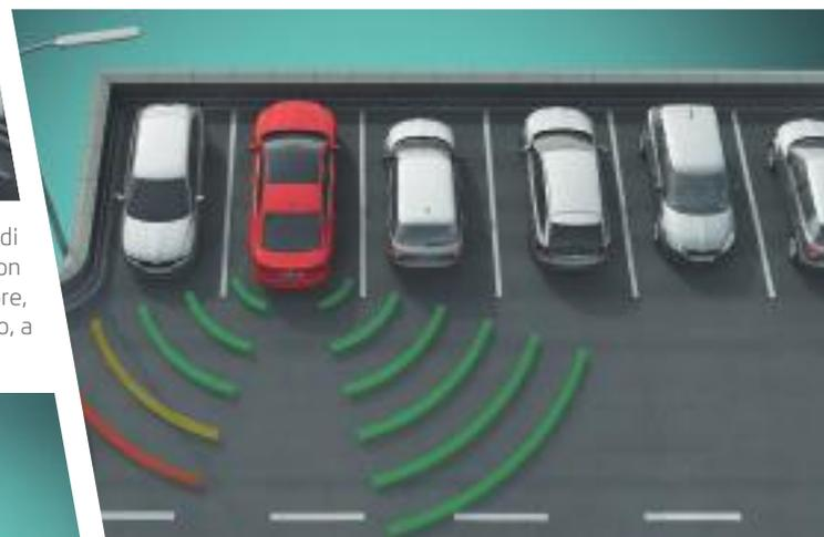
Il Rear Traffic Alert, utilizza i sensori del Blind Spot Detect per aiutare il conducente nelle manovre di retromarcia in condizioni di scarsa visibilità, come, ad esempio, in caso di uscita da un parcheggio. Se il sistema rileva la presenza di veicoli in fase di avvicinamento, avvisa il guidatore del pericolo mediante un avvertimento acustico e visivo e, in caso di estrema necessità, attiva la funzione di frenata d'emergenza automatica.
