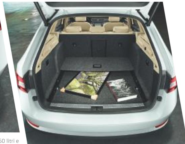
Il piano di carico variabile accresce ulteriormente la praticità del bagagliaio di Superb Wagon: permette di posizionare il fondo del vano all'altezza della soglia di carico, creando, inoltre, un pratico e nascosto vano portaoggetti al di sotto del piano stesso.
