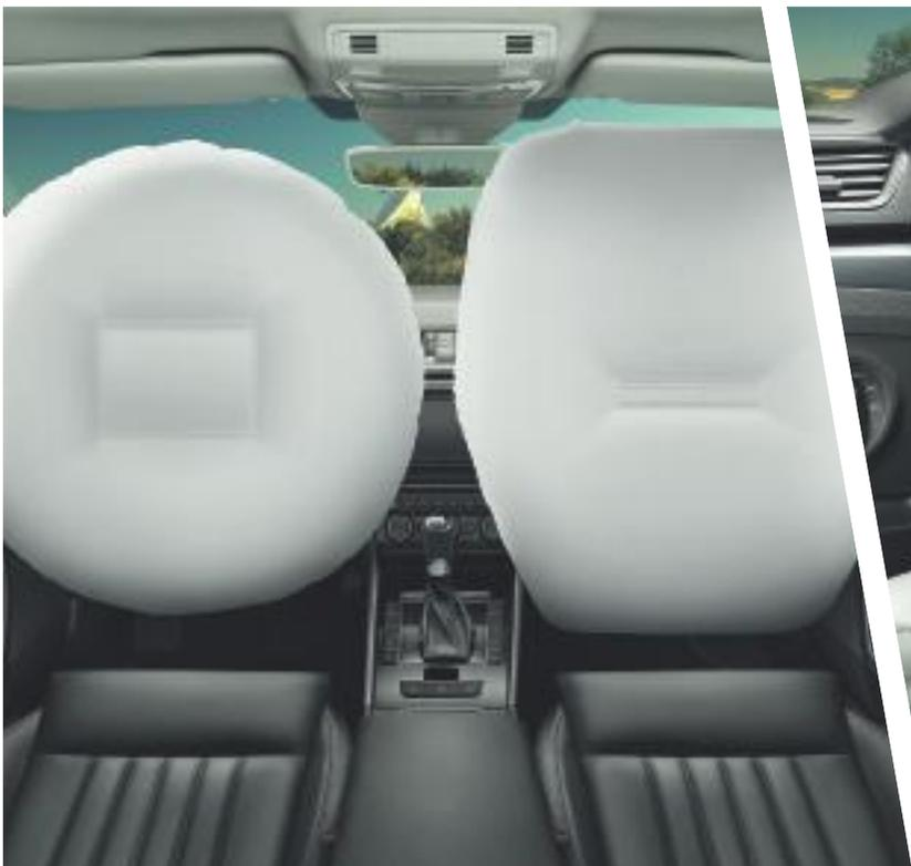
Mentre l'airbag frontale per il conducente è posto nel volante, l'airbag per il passeggero si trova nel cruscotto e può essere disattivato per collocare un seggiolino per bambini sul sedile anteriore.
