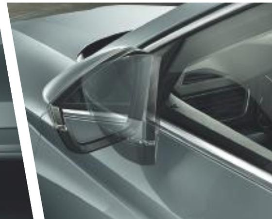
Gli specchietti retrovisori esterni ripiegabili elettricamente, si dimostrano particolarmente utili quando si parcheggia nelle strade di città. Sono inoltre schermabili automaticamente e dotati di funzione memory.
