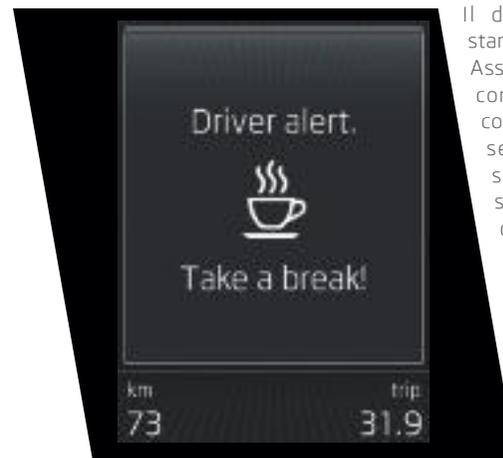
Il dispositivo di rilevamento della stanchezza del conducente (Driver Activity Assist), grazie ai dati inviati dal sistema di controllo del servosterzo, monitora il comportamento di guida; qualora rilevi segnali imputabili a stanchezza o sonnolenza, suggerisce di fare una sosta mediante un messaggio sul display MaxiDOT.
