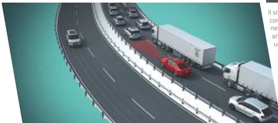
Il Traffic Jam Assist è un'avanzata funzionalità di guida semiautonomo in coda. In caso di incolonnamento nel traffico, il sistema, presente sulle vetture con cambio DSG equipaggiate con Adaptive Cruise Control e Lane Assist, interviene direttamente ed autonomamente su motore, freni e sterzo facendo avanzare il veicolo in base alla velocità delle vetture che precedono, a condizione che la velocità sia inferiore a 60 km/h e che il conducente impugni il volante.
