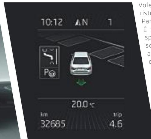
Volete parcheggiare in spazi ristretti con il minimo sforzo? Il Park Assist fa al caso vostro! È in grado di individuare lo spazio più adatto (necessita solo di 60 cm in più rispetto alla lunghezza della vettura) e di effettuare autonomamente le manovre di parcheggio parallelo o perpendicolare alla carreggiata.
