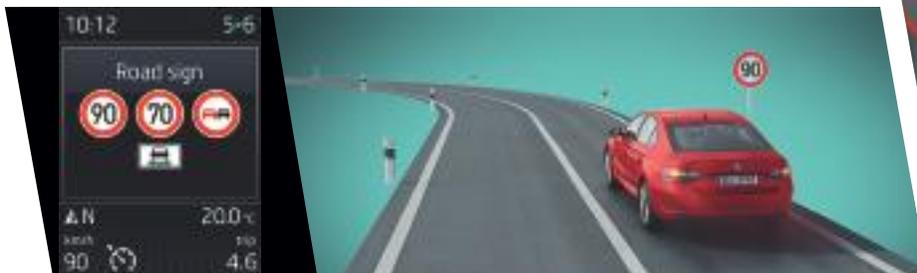
Grazie alla telecamera multifunzione, il sistema Travel Assist è in grado di riconoscere e visualizzare i principali segnali stradali sul display del MaxiDOT o del sistema di navigazione Amundsen o Columbus.
