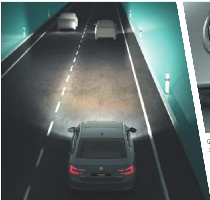
Grazie allo Smart Light Assist potrete utilizzare i fari di profondità senza temere di abbagliare le vetture che viaggiano in direzione opposta alla vostra; questo sistema, utilizzando la telecamera multifunzione posizionata alla base dello specchietto retrovisore interno, è in grado non solo di alternare abbaglianti e anabbaglianti, ma anche di attenuare le luci di profondità a seconda delle condizioni del traffico.
