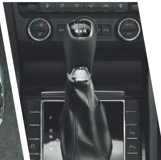
A seconda del tipo di motore, l'auto può montare il cambio automatico DSG (Direct Shift Gearbox) a 6 rapporti o 7 rapporti a seconda della motorizzazione.
