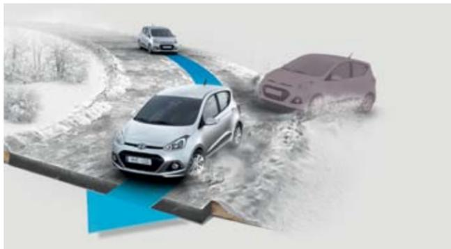
**Controllo elettronico della stabilità (ESP).** Tramite sensori che rilevano velocità e dati di imbardata, il sistema applica una diversa forza frenante alle singole ruote per evitare sbandate incontrollate in situazioni di guida estreme.
