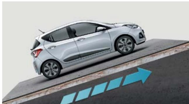
**Hill Assist Control (HAC).** Le partenze in salita non sono mai state così facili, grazie a questo dispositivo che aziona automaticamente i freni per brevi istanti impedendo possibili arretramenti.
