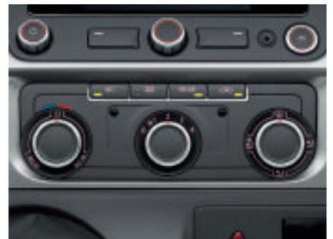
**Climatizzatore "Climatic"** per cabina guida con secondo evaporatore per il vano passeggeri. Il climatizzatore semiautomatico consente di regolare la temperatura sia della cabina che del vano passeggeri per aumentare il comfort degli ospiti.
