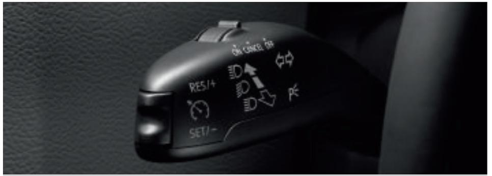
**Regolatore di velocità.** A partire da 30 km/h, è possibile mantenere la velocità al livello impostato premendo un pulsante. Il sistema può essere disattivato premendo brevemente il pedale del freno.
