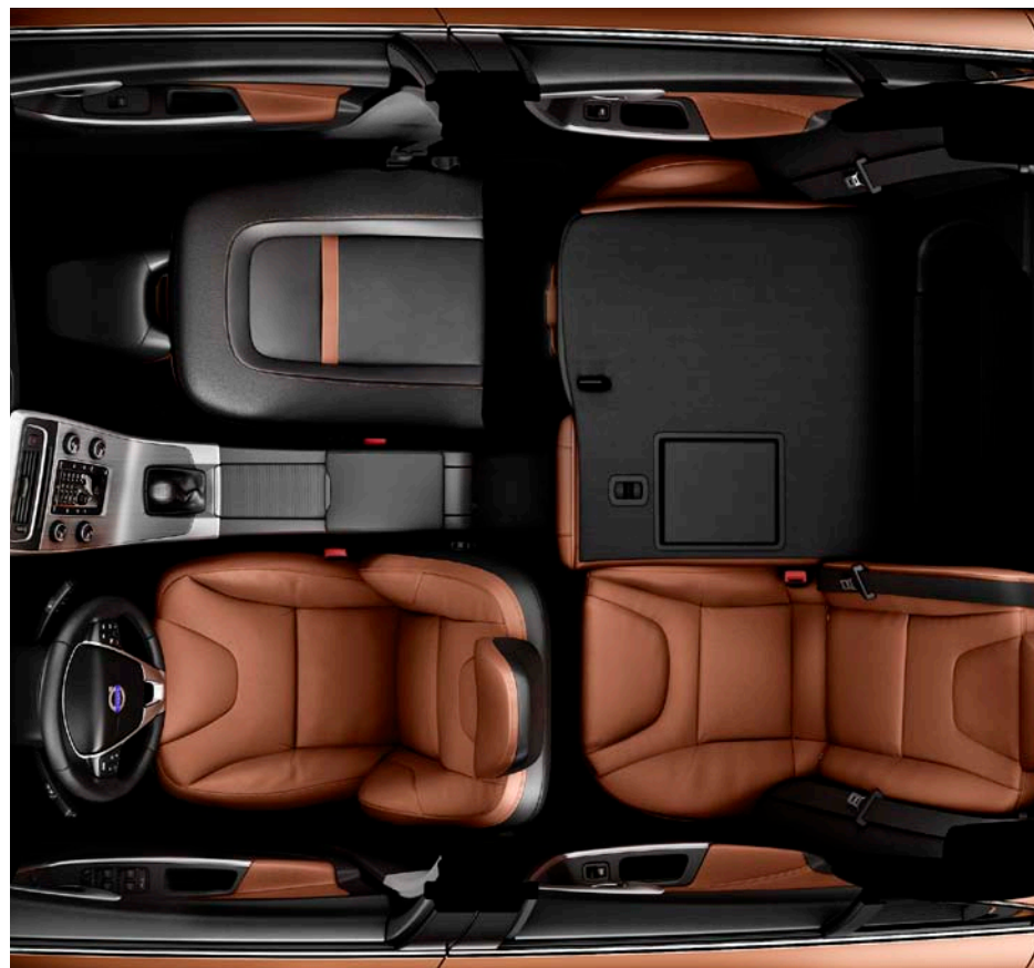
Divano posteriore frazionabile con rapporto di 60/40 Schienale del sedile del passeggero anteriore ribaltabile
