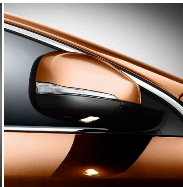
Retrovisori esterni ripiegabili elettricamente con illuminazione del suolo
