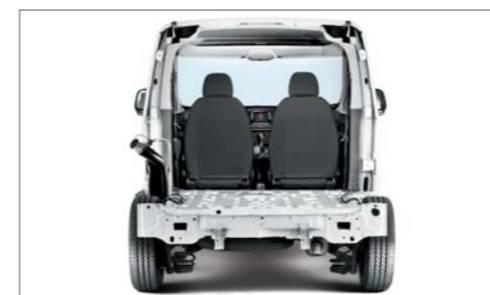
Punti di ancoraggio su cabina e pianale, la miglior predisposizione per ogni tipo di allestimento
