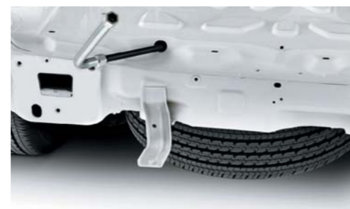
Ruota di scorta accessibile dal posteriore compatibile con la maggior parte degli allestimenti (opt. 980)
