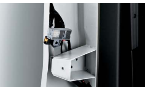
Presse trasformatori - interfaccia elettrica per connettere le utenze dell'allestimento (opt. 081)
