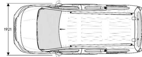
Breite mit eingeklappten Außenspiegeln 1921 mm
