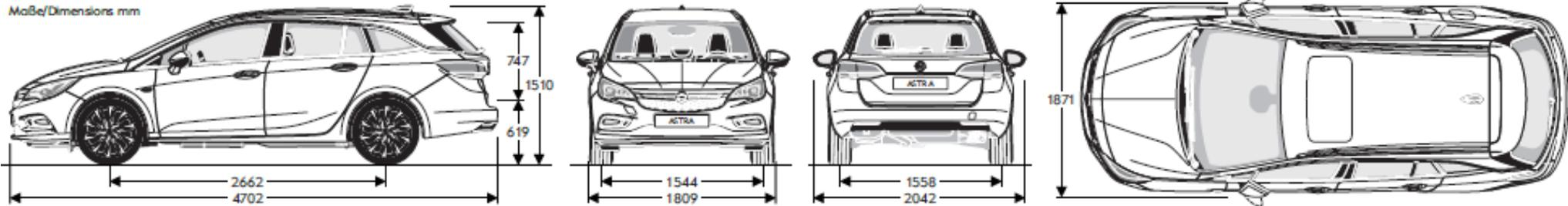
Breite mit eingeklappten Außerspiegeln 1871 mm
