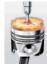
**La preiniezione** consente una combustione «morbida» e quindi una minore rumorosità e un funzionamento più dolce del motore.
