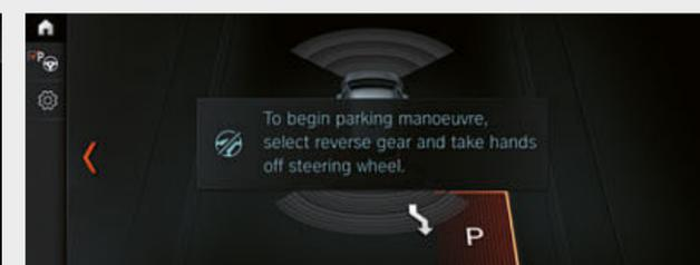
□ Il Parking Assistant<sup>9</sup> vi facilita le manovre di parcheggio parallele alla corsia di marcia. A tale scopo, il sistema misura le dimensioni dei posti di parcheggio, se si viaggia a bassa velocità. Quando viene rilevato uno spazio adatto, il Parking Assistant prende il controllo dello sterzo, mentre inserite la marcia corretta, premete il pedale dell'acceleratore o frenate.
