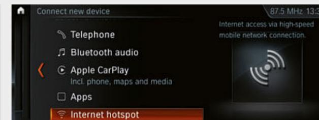
□ L'equipaggiamento comprende un hot spot<sup>6</sup> integrato con connessione standard LTE, che permette di usufruire di una connessione Internet (a pagamento). La connessione avviene attraverso una SIM card installata nella vettura e previo acquisto del traffico dati.
