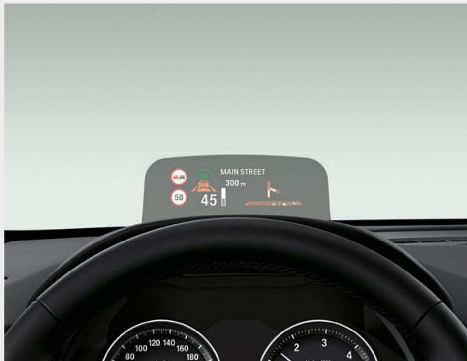
□ Il BMW Head-Up Display<sup>1</sup> multicolore proietta tutte le informazioni rilevanti per la guida su un pannello nel campo visivo del conducente, permettendogli di restare concentrato sulla strada. Tra le informazioni visualizzate sono incluse la velocità, le indicazioni del sistema di navigazione, lo Speed Limit Info con indicatore di divieto di sorpasso, la rubrica telefonica e le voci dell'entertainment.
