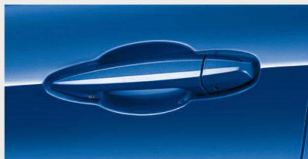
□ Il Comfort Access System permette ai passeggeri di salire a bordo dalle porte anteriori e aprire il portellone posteriore senza bisogno di utilizzare la chiave. La chiave deve trovarsi nelle vicinanze, ad esempio nella tasca del conducente. Per aprire le porte, è sufficiente toccare le maniglie delle portiere o il pulsante del portellone.
