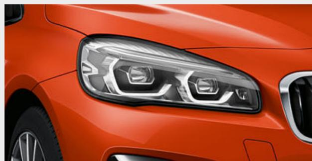
□ I fari LED adattivi anabbaglianti ed abbaglianti comprendono indicatori di direzione realizzati completamente con tecnologia LED. L'equipaggiamento comprende il BMW Selective Beam, le luci di svolta, le luci diurne e l'Adaptive Light Control (illuminazione adattativa in curva) con distribuzione variabile del fascio luminoso per illuminare in modo ottimale la strada e migliorare la visibilità nell'oscurità.
