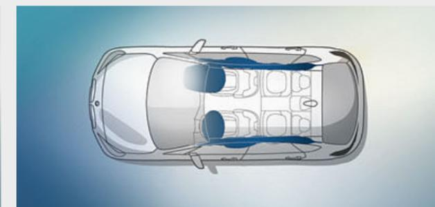
■ Gli **airbag per la testa** della prima e della seconda fila di sedili completano l'equipaggiamento airbag della vettura. Situati lungo la superficie dei finestrini, costituiscono un sistema di protezione per la testa e proteggono anche i passeggeri posteriori da eventuali oggetti che potrebbero penetrare nell'abitacolo.
