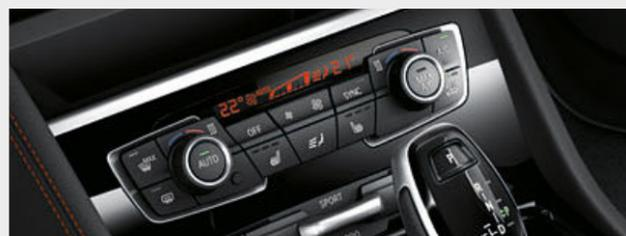
□ Il climatizzatore automatico bizona<sup>2</sup> con controllo automatico della temperatura ha comandi separati per il conducente e il passeggero. Sono inclusi il controllo automatico del ricircolo dell'aria, un microfiltro a carboni attivi, un sensore luce e antiappannamento e bocchette di aerazione posteriori.
