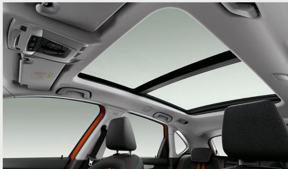
□ Aperto, il tettuccio panoramico in vetro offre un maggiore flusso di aria esterna all'interno dell'abitacolo. Chiuso, crea un'atmosfera luminosa e piacevole. Si apre e si chiude automaticamente premendo un pulsante o a distanza, è sollevabile e scorrevole ed è dotato di tendina parasole avvolgibile e di deflettore antivento.
