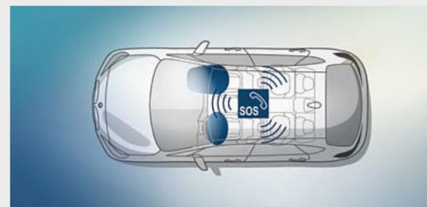
■ In caso di necessità, l'**Emergency Call** mette in contatto automaticamente il guidatore con il centro di coordinamento del soccorso attraverso il Call Center BMW, indipendentemente dalla presenza a bordo di un telefono cellulare. Trasmette informazioni riguardanti la posizione del veicolo e la gravità dell'incidente. L'Emergency Call può essere effettuata anche manualmente, ad esempio nel caso di necessità di altri utenti della strada.
