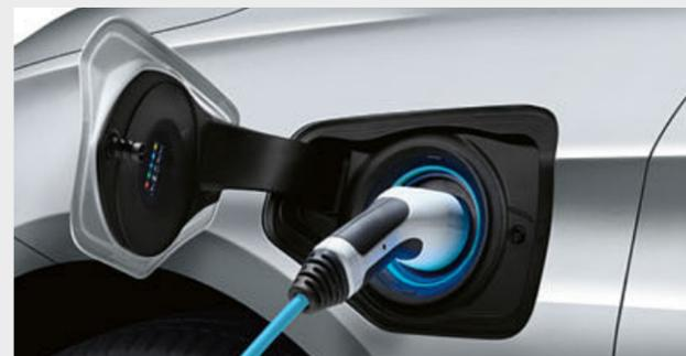
L'attacco per la ricarica della batteria ad alte prestazioni si trova sotto uno sportellino sulla fiancata anteriore sinistra della vettura. Una guarnizione speciale protegge sia il connettore che l'attacco di ricarica dagli elementi atmosferici. Il livello di ricarica è visibile dalla spia a LED presente sull'attacco.
