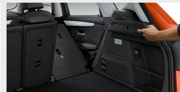
□ Lo sblocco a distanza dello schienale<sup>7</sup> posteriore permette allo schienale di essere sbloccato e ripiegato comodamente con un pulsante nel vano bagagli.
