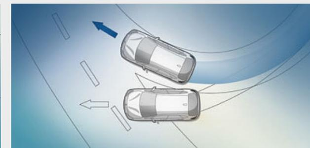
■ Il **Controllo dinamico di stabilità (DSC)** rileva continuamente le condizioni di marcia grazie a diversi sensori e, se queste ultime diventano instabili, stabilizza la vettura con la gestione di motore e freni. Altre funzioni del DSC sono ad esempio Predispersione alla frenata, Asciugatura dei freni sul bagnato o Automatic Hold.
