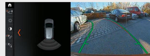
□ La telecamera posteriore con linee guida di manovra migliora inoltre l'orientamento durante la retromarcia a velocità inferiori a 15 km/h, ad esempio nelle manovre di parcheggio. Visualizza sul Control Display la zona dietro la vettura. Le linee interattive misurano la distanza e il diametro di sterzata, assistendovi nella manovra. Gli ostacoli sono contrassegnati mediante colori.
