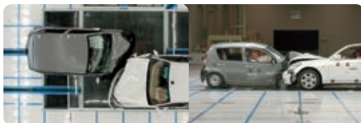
Crash Test frontale asimmetrico
