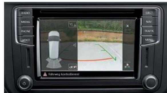
**Telecamera per la retromarcia "Rear View".**<sup>1)</sup> Facilita il parcheggio visualizzando sul display dell'impianto radio o del sistema di navigazione<sup>2)</sup> un'immagine limitata della zona retrostante il veicolo. Le linee guida statiche supportano le manovre di parcheggio. La telecamera per la retromarcia è disponibile soltanto in combinazione con il portellone.
