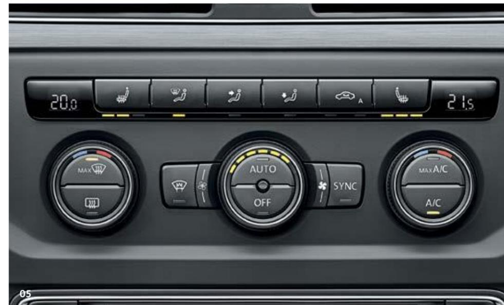
**04 Climatizzatore.** Il climatizzatore semiautomatico può essere regolato in modo continuo e provvede a mantenere sempre gradevolmente temperato il clima nell'abitacolo. Grazie alle manopole e ai pulsanti ergonomici e di grandi dimensioni, durante la marcia è possibile regolare facilmente la temperatura, la modalità di distribuzione dell'aria e la velocità della ventola. | **TL** |
