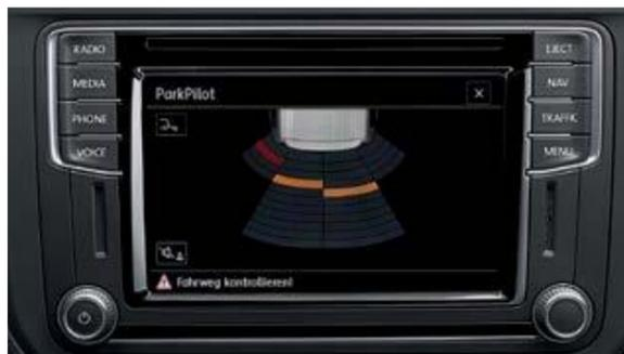
**Park Pilot.**<sup>1)</sup> In fase di parcheggio, se il sistema riconosce la presenza di ostacoli nella zona posteriore, avvisa con un segnale acustico e visualizza sul display la distanza del veicolo dagli oggetti rilevati.<sup>2)</sup>
