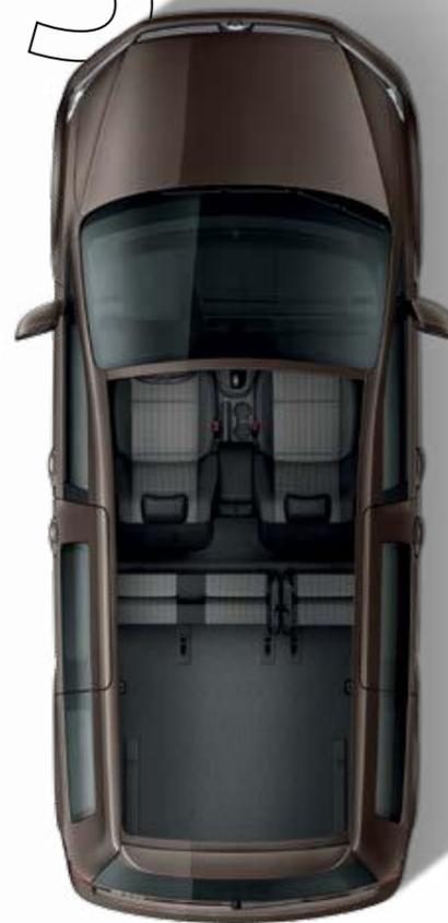
Abbattendo e ripiegando la seconda fila di sedili si ha a disposizione un volume del vano di carico pari a 2.852 l.
