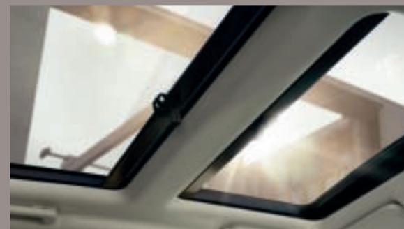
**TETTO PANORAMICO** Il tetto panoramico opzionale, con sezione posteriore fissa e quella anteriore apribile elettricamente, aggiunge ariosità all'abitacolo. Il vetro è realizzato in modo da filtrare i raggi infrarossi del sole, facendo passare la luce ma non il calore. Entrambe le sezioni sono dotate di pratica tendina.
