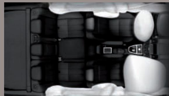
**SICUREZZA** Per la realizzazione della carrozzeria monoscocca e della cellula interna di sicurezza è stato impiegato acciaio ad altissima resistenza. Inoltre, la cellula di sicurezza è protetta da zone a deformazione progressiva anteriori e posteriori. Nove punti di protezione airbag sono di serie su tutti i modelli. La Freelander 2 è stata la prima della sua categoria a ottenere il punteggio di cinque stelle per la sicurezza dei passeggeri adulti nei rigorosi test Euro NCAP.
