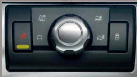
**TERRAIN RESPONSE®** Il sistema Terrain Response®\* brevettato da Land Rover aumenta la versatilità d'utilizzo della Freelander 2. I quattro programmi – guida generica, erba/ghiaia/neve, fango e solchi, o sabbia – sono facilmente selezionabili tramite il selettore rotante. Inoltre, tutti i veicoli dotati di Terrain Response® dispongono anche dei sistemi di Controllo automatico della velocità in discesa\* e Gradient Release Control di Land Rover\*.
