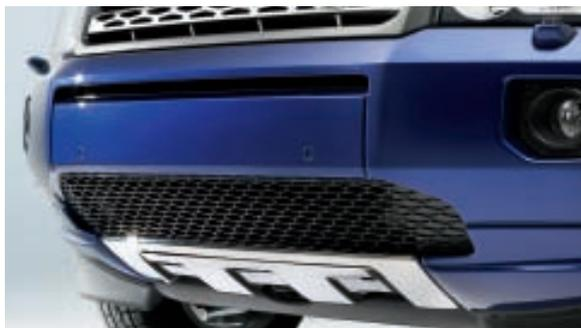
**Piastra sottoscocca in acciaio inox**
