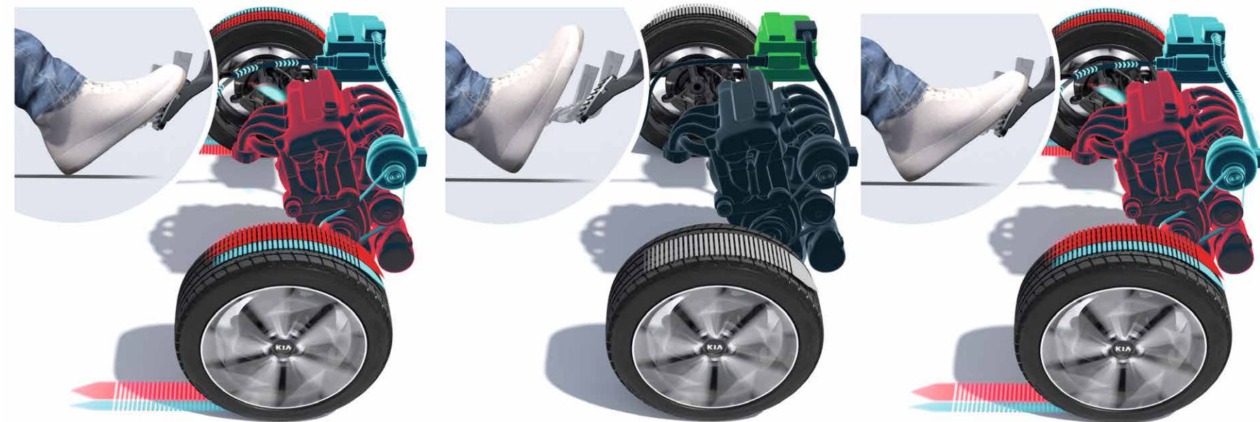
Rappresentazione schematica della funzione "coasting" nel sistema mild hybrid con IMT.
