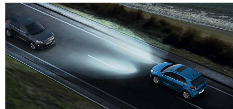
Sistema di regolazione automatica dei fari abbaglianti (HBA). Nel caso di abbaglianti attivi di notte, la telecamera integrata nel parabrezza rileva i veicoli in avvicinamento nella corsia opposta ed attiva automaticamente gli anabbaglianti per evitare di infastidire gli altri guidatori. Una volta incrociato il veicolo, si riattivano gli abbaglianti.
