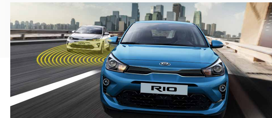
Sistema di monitoraggio dell'angolo cieco (BCW). Quando vuoi cambiare corsia, il sistema BCW rileva l'eventuale presenza di veicoli nel punto cieco e attiva una spia nel retrovisore laterale e una sul cruscotto, accompagnate da un segnale acustico.
