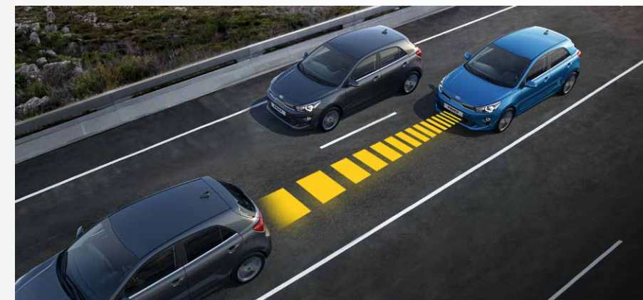
Smart Cruise Control (SCC). Usando il radar integrato, il sistema SCC regola automaticamente la velocità di Nuova Kia Rio e la distanza dal veicolo che precede. Se il veicolo rallenta e non è più possibile mantenere la distanza di sicurezza, l'SCC riduce la velocità – fino al completo arresto dell'auto. Se il veicolo che precede accelera, anche Nuova Kia Rio aumenta la velocità fino al valore preimpostato.
