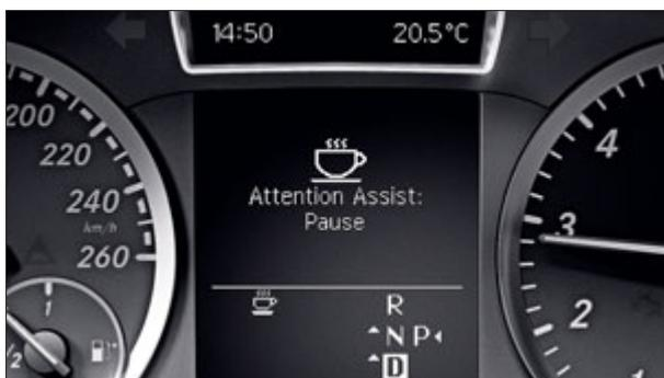
Non appena riconosce le prime avvisaglie di stanchezza o di disattenzione, l'ATTENTION ASSIST suggerisce al guidatore di interrompere il viaggio con una pausa.
