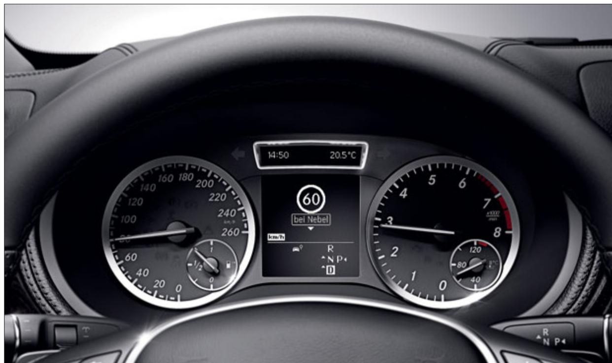
Lo Speed Limit Assist ricorda al guidatore i limiti di velocità in corso.
