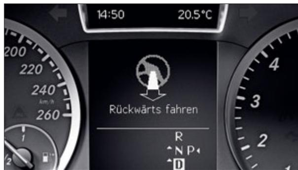
Il display nella strumentazione fornisce al guidatore un quadro della situazione sulla manovra di parcheggio in corso.
