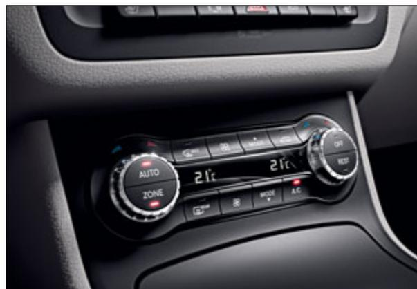
Climatizzatore automatico COMFORTMATIC
