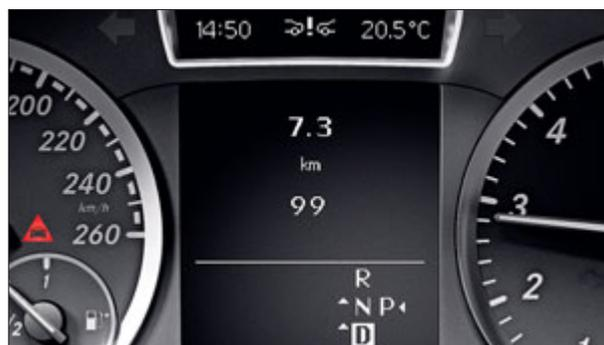
In caso di distanza di sicurezza eccessivamente ridotta, il COLLISION PREVENTION ASSIST allerta il guidatore con un segnale visivo e acustico.
