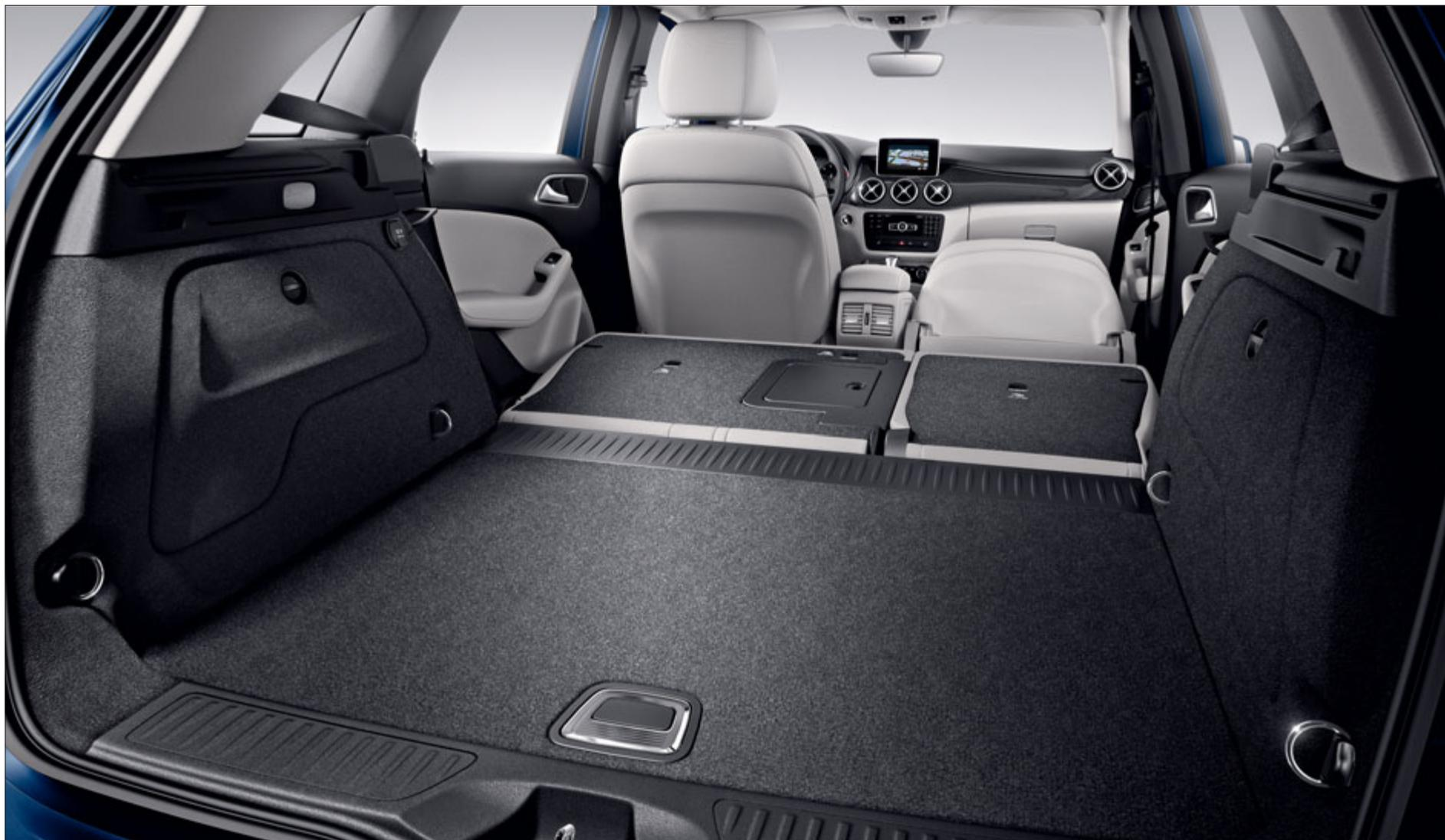
Con i sedili posteriori completamente abbattuti si ottiene un volume di carico di 1545 litri con una superficie di carico pressoché piana.
