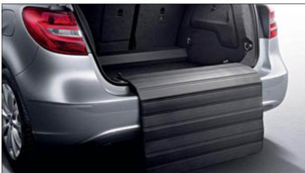
La protezione del bordo di carico pieghevole copre il paraurti e il bordo di carico.
