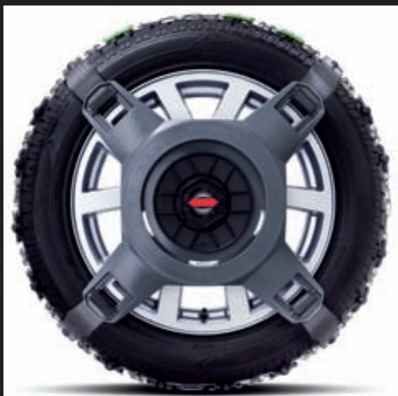
Sistema "track" per trazione su neve LR005737 Solo ruote anteriori da 18", 19" e 20".
