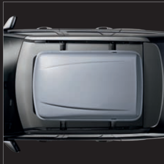
Box portabagagli* VPLDR0003 L'apertura è possibile da entrambi i lati. Con serratura a chiave. Dimensioni esterne: lunghezza 1.600 mm, larghezza 960 mm, altezza 410 mm. Capacità 450 litri. Carico massimo 54,8 kg.
