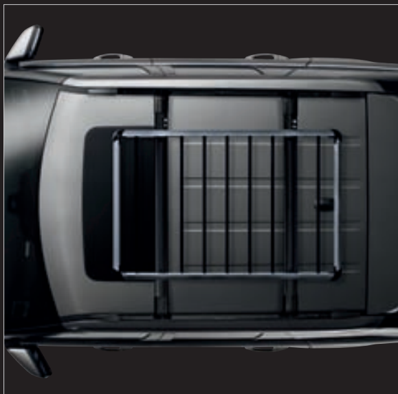
Cestello portabagagli* LR006848 Carico massimo 62,6 kg.
