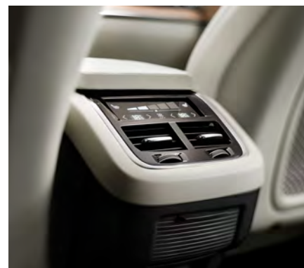
I comandi del climatizzatore a quattro zone sono azionabili dal touch screen del display centrale o dal pannello touch screen alla fine della consolle sul tunnel.
