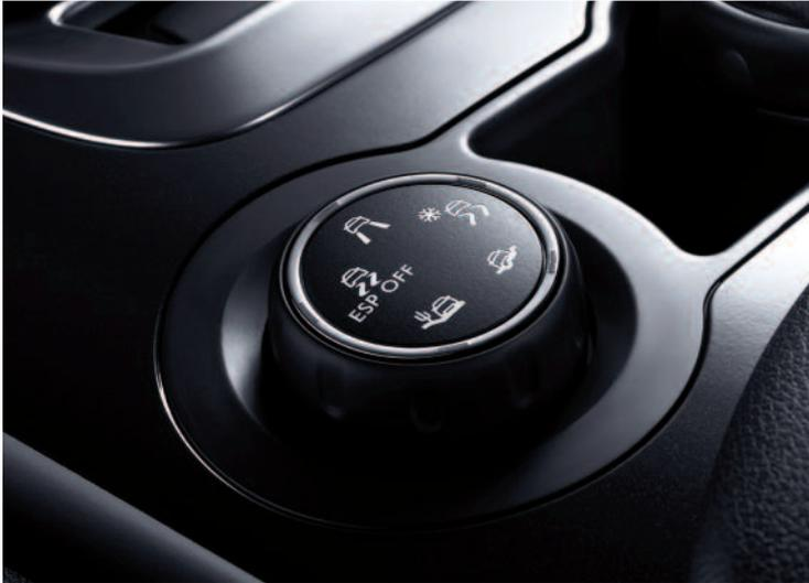
Neve, fango o sabbia, la manopola del Grip Control®; sul tunnel centrale, vi consente di scegliere la modalità adatta al terreno sul quale state viaggiando. La gestione della trazione può essere regolata in base a cinque alternative:
