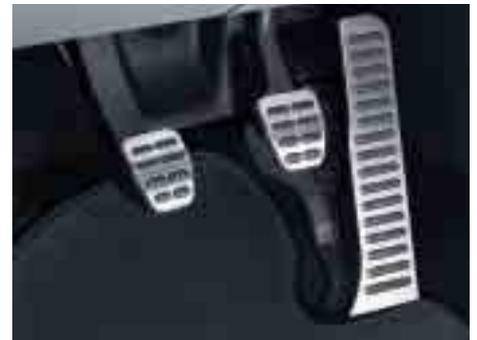
**Set pedaliere.** Pedaliere antisdrucchiolo in acciaio spazzolato con rivestimento in gomma. Il set è composto da pedaliere per i pedali di acceleratore, freno e frizione. Il pedale elettronico dell'acceleratore è compreso nella fornitura.
