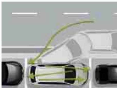
L'assistente di guida al parcheggio "Park Assist" verifica, tramite sensori ad ultrasuoni, l'area sul lato conducente e passeggero anteriore indicandoti gli spazi più idonei per parcheggiare e aiutandoti nella manovra.
