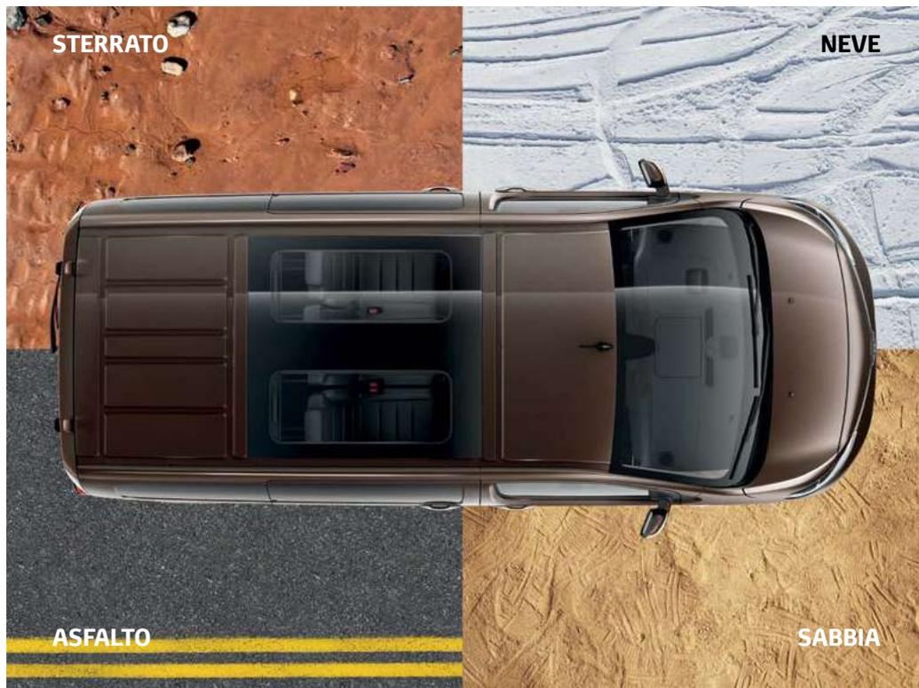
Il Toyota Traction Select (di serie su Luxury) permette al guidatore di cambiare la risposta di motore, acceleratore e controllo di stabilità in base al tipo di superficie sulla quale la vettura sta viaggiando. Il guidatore può scegliere tra le modalità Asfalto, Neve, Sterrato e Sabbia e potrà sempre contare su massimi livelli di trazione e sicurezza in ogni condizione di guida.
