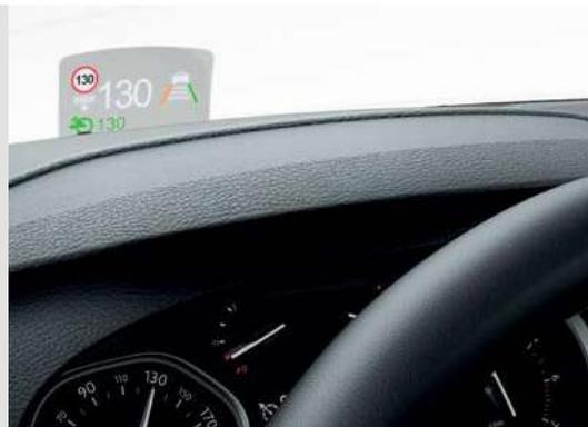
L'Head-Up Display sull'allestimento Luxury proietta, su uno schermo posizionato esattamente sulla linea d'orizzonte del guidatore, una serie di informazioni essenziali alla guida, quali la velocità, le impostazioni del cruise control e gli avvisi di sicurezza.
