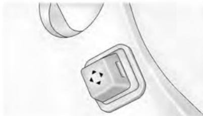
Per i veicoli con il volante inclinabile elettrico, il comando si trova sul lato sinistro del piantone dello sterzo.
