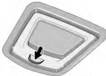
Premere sul fondo del gruppo della maniglia del pianale di carico per sollevare la punta sulla maniglia. Sollevare la maniglia per aprire il sistema di gestione del carico.
