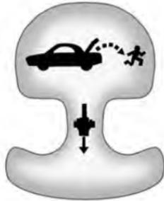
**Osservazione:** Non usare la maniglia di sblocco di emergenza del bagagliaio come elemento di fissaggio o punto di ancoraggio quando sono assicurati oggetti nel bagagliaio, altrimenti si rischia di danneggiare la maniglia. La maniglia di sblocco di emergenza del bagagliaio è destinata esclusivamente come mezzo di assistenza di una persona intrappolata in un
