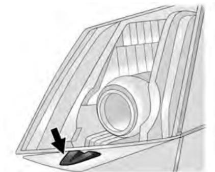
Premere il pulsante posizionato sull'estremità della leva del lavacrystallo per lavare i proiettori. Verranno lavati sia i proiettori che il parabrezza. Dopo il primo lavaggio, i proiettori non saranno più lavati fino a che il pulsante del tergicristalli non sia premuto per la quinta volta.
