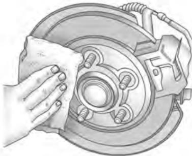
10. Rimuovere la ruggine e la sporcizia dai bulloni ruote, dalle superfici di montaggio e dal pneumatico di scorta.
