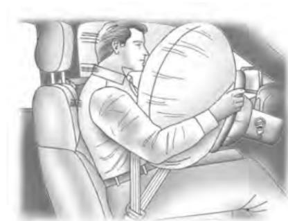
L'airbag frontale del conducente si trova al centro del volante.
