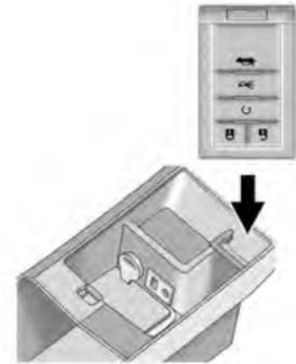
Se spostare il trasmettitore all'interno del veicolo non serve, posizionarlo nel vano trasmettitore della console centrale, con i pulsanti rivolti verso la parte anteriore del veicolo, ed avviare il veicolo.
