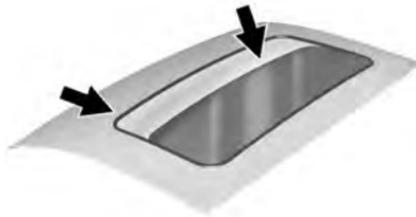
È possibile che sporcizia e altre impurità possano accumularsi nel guida o nella guarnizione del tettuccio apribile. Ciò potrebbe causare un problema con il funzionamento del tetto o il rumore.
