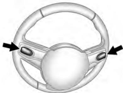
Se presenti, i comandi del cambio sequenziale si trovano sul retro del volante. I comandi del cambio sequenziale possono essere utilizzati in D (Drive), M (modalità manuale) con cambiata automatica in modalità Sport attiva o (M modalità manuale) con modalità di cambiata manuale.
