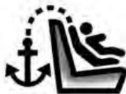
Per agevolare l'individuazione degli ancoraggi Top Tether, il simbolo dell'ancoraggio si trova sulla copertura.
