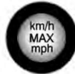
16. Se è stato possibile gonfiare il pneumatico a terra fino alla pressione raccomandata, rimuovere l'etichetta relativa alla velocità massima dal contenitore del sigillante (5) e posizionarla in un punto in cui goda della massima visibilità. Non superare la velocità indicata su questa etichetta
