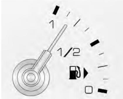
Con accensione inserita, l'indicatore del livello carburante indica la quantità di carburante residuo nel serbatoio.
