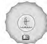
Il tappo del serbatoio del liquido della frizione idraulica riporta questo simbolo. Per la posizione del serbatoio, vedere *Panoramica del vano motore* a pagina 10-5.
