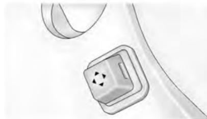
Per veicoli con la regolazione elettrica del volante, il comando si trova sul lato sinistro del piantone dello sterzo.
