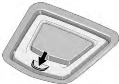
Premere il pulsante del gruppo maniglia del pavimento di carico per sollevare la parte superiore della maniglia. Sollevare la maniglia per aprire il sistema di gestione del carico.
