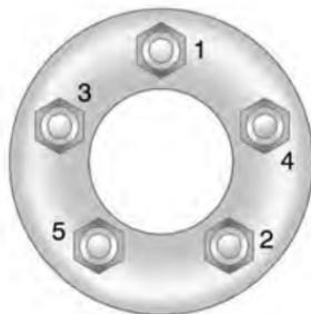
15. Serrare i dadi ruote saldamente in sequenza incrociata, come mostrato in figura.
