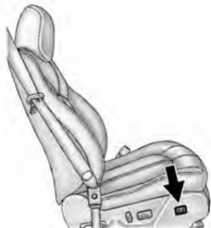
Se presente, mantenere premuto il comando posto sul lato esterno del sedile in avanti o all'indietro per aumentare o diminuire il supporto lombare del sedile del conducente o passeggero anteriore.
