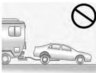
**Importante:** Trainare un veicolo a trazione integrale con tutte le quattro ruote a terra, o anche con due sole, danneggerebbe i componenti del gruppo propulsore. Non trainare un veicolo a trazione integrale con nessuna ruota poggiata al suolo.
