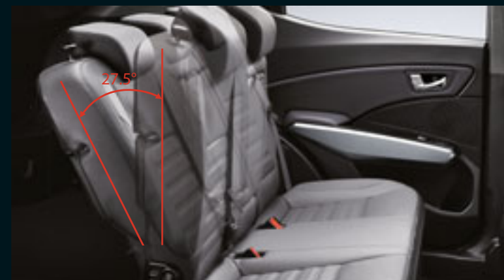
Sedile posteriore inclinato a 27,5°
