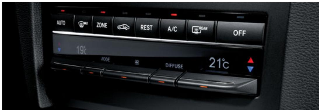
Il climatizzatore automatico COMFORTMATIC può essere comandato dal cockpit o da un'unità di comando nel vano posteriore.
