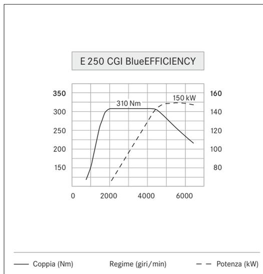
Efficiente e rispettoso delle risorse: il 4 cilindri a benzina della E 250 CGI BlueEFFICIENCY
