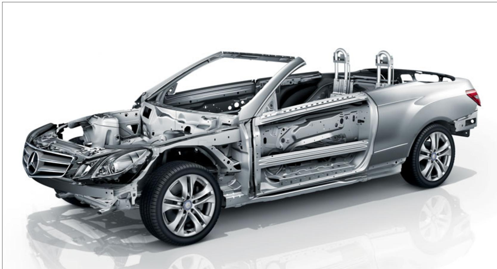
Oltre alla protezione antiribaltamento e al telaio del tetto, anche l'impiego di differenti tipi di acciaio nella carrozzeria aumenta ulteriormente la sicurezza della Classe E Cabrio.
