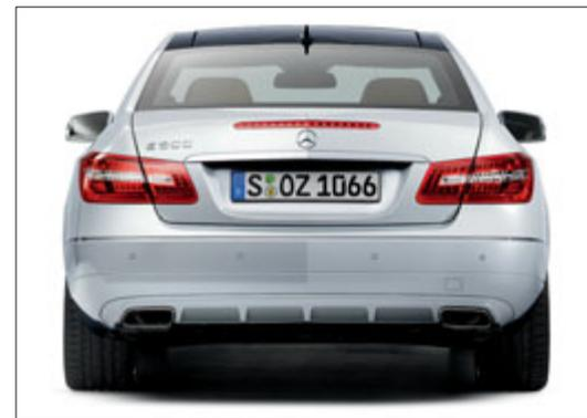
Il modello a 8 cilindri si riconosce dall'impianto di scarico a due uscite con terminali di scarico trapezoidali.
