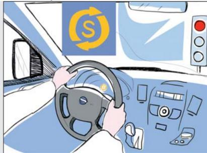
● Start&Stop è il sistema che spegne automaticamente il motore quando le condizioni del traffico impongono un arresto del veicolo, come semafori rossi, code, soste temporanee. Il motore viene successivamente riavviato premendo il pedale della frizione. Pensato in particolare per gli spostamenti in città, è in grado di garantire fino al 15% di risparmio carburante con conseguente sensibile riduzione anche delle emissioni.
