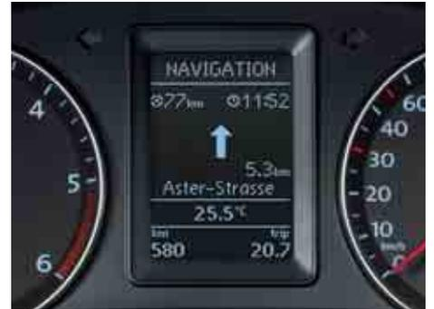
Il display multifunzione “Plus”. Oltre alle funzioni del display multifunzione, consente di regolare anche il riscaldamento supplementare ad acqua e il pacchetto Luce e visibilità (optional). Inoltre vengono visualizzate le frecce di direzione dei sistemi di navigazione opzionali e, insieme alla predisposizione per cellulari (anch’essa opzionale), è possibile comandare anche un telefono cellulare.
