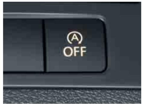
**Il sistema Start/Stop.** Aiuta il conducente a ridurre il consumo di carburante. Alle soste ai semafori, il sistema spegne automaticamente il motore e lo riavvia non appena si prosegue la marcia.
