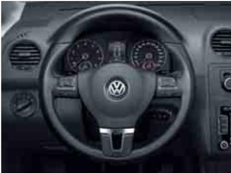
Il volante multifunzione. Il volante multifunzione a 3 razze è rivestito in pelle ed è regolabile in altezza e inclinazione. Con gli interruttori integrati si comandano ad esempio la radio, il sistema di navigazione e un telefono cellulare.
