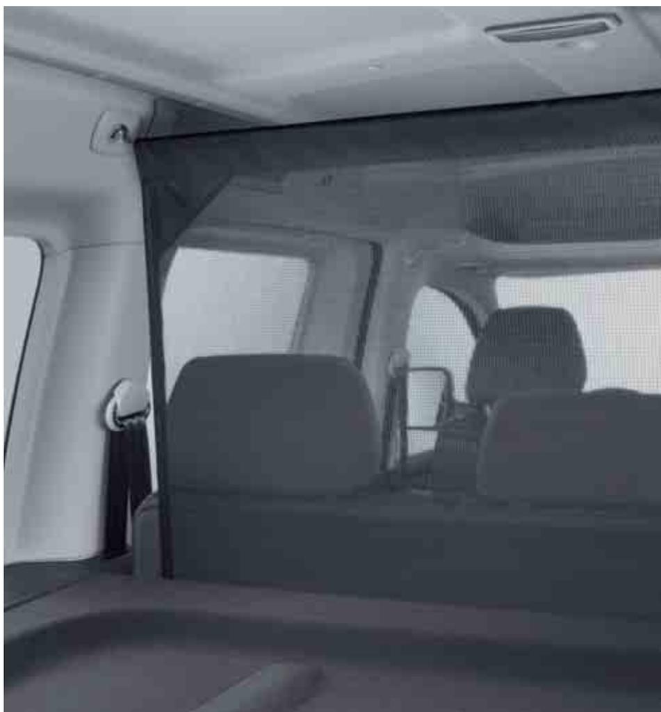
La rete di separazione. La rete fermabagagli offre una protezione passiva contro lo spostamento improvviso dei bagagli in caso di brusche frenate. È possibile tenderla su punti di fissaggio dietro il montante centrale e posteriore e, all'occorrenza, arrotolarla.
