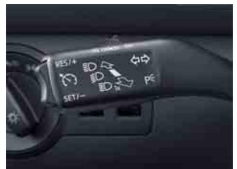
**Il regolatore di velocità.** A partire da 30 km/h mantiene costante la velocità impostata. Così non devi sempre tenere premuto il pedale dell'acceleratore. Inoltre, procedendo in modo uniforme si riducono i consumi di carburante.
