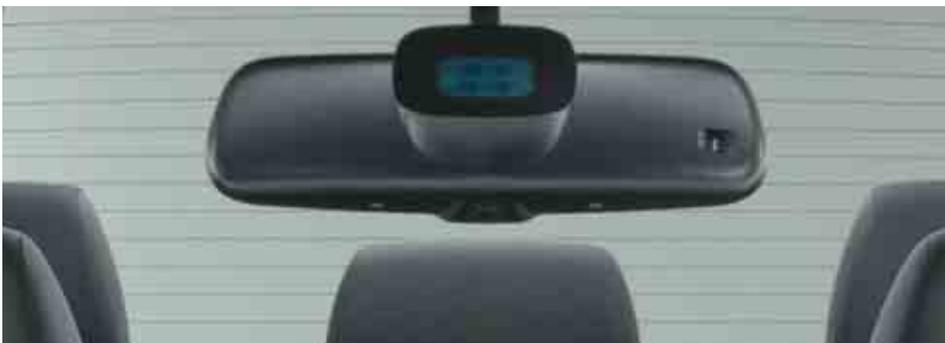
**Il pacchetto Luce e visibilità.** Lo specchietto retrovisore si oscura automaticamente nel caso i fari del veicolo che segue siano troppo luminosi. Il sensore applicato nel supporto dello specchietto retrovisore accende automaticamente i proiettori quando diventa buio. Quando inizia a piovare, attiva il tergicristallo, adattandone la velocità in base all'intensità della pioggia.
