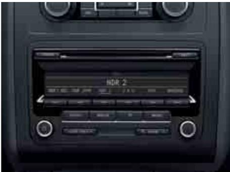
L'impianto radio "RCD 310". Dispone di tutte le funzioni della radio "RCD 210" e un display più grande. È dotato di interfaccia AUX-IN.
