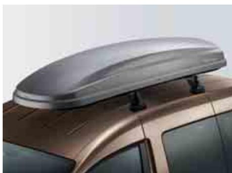
I **box portabagagli**. Facili da montare, con serratura, da 310, 340 e 460 litri. Consentono l'apertura da entrambi i lati. Solo in abbinamento alle barre portatutto.
