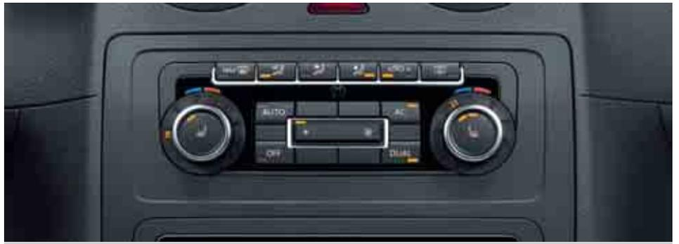
Il climatizzatore “Climatronic”. Il climatizzatore automatico con regolazione della temperatura a due zone mantiene costante la temperatura desiderata nell’abitacolo. I sensori rilevano le variazioni di temperatura e mantengono costante la temperatura del vano passeggeri, regolando in modo automatico il numero giri della ventola e la temperatura dell’aria.
