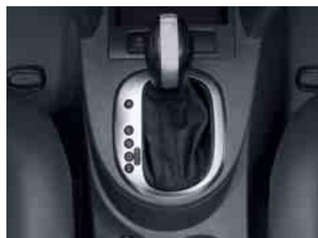
Il **cambio a doppia frizione (DSG)**. A seconda della motorizzazione, è disponibile con sei o sette rapporti. La doppia frizione consente di cambiare marcia in modo completamente automatico, senza nessuna interruzione della forza di trazione. Disponibile per il motore 1.6 TDI 75 kW\*. È inoltre possibile abbinare cambio DSG e trazione 4MOTION con il motore 103 kW TDI.
