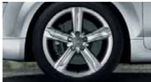
■ Cerchi in lega di alluminio, design a 5 razze dinamico 9 J x 18 con pneumatici 245/40 R 18, a richiesta con pneumatici Runflat
