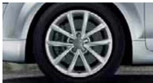
■ Cerchi in lega di alluminio a 5 razze a V, 8,5 J x 17 con pneumatici 245/45 R 17, a richiesta con pneumatici Runflat (di serie per 2.0 TFSI e 2.0 TDI)
