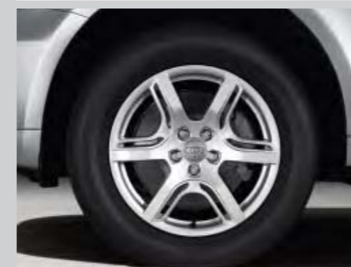
Cerchi in lega di alluminio a 6 razze paraboliche, 8 J x 18 con pneumatici 235/60 R 18
