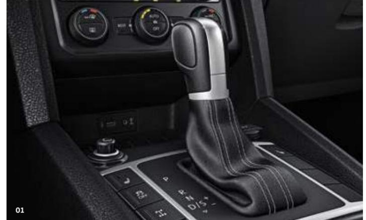
**01 Cambio automatico a 8 rapporti e trazione integrale permanente 4MOTION.** Solo Nuovo Amarok offre l'esclusiva combinazione del confortevole cambio automatico a 8 rapporti con la trazione integrale permanente 4MOTION. Il primo rapporto è per l'impiego fuoristrada, mentre l'ottavo è ottimizzato per viaggi parchi nei consumi ai bassi regimi.
